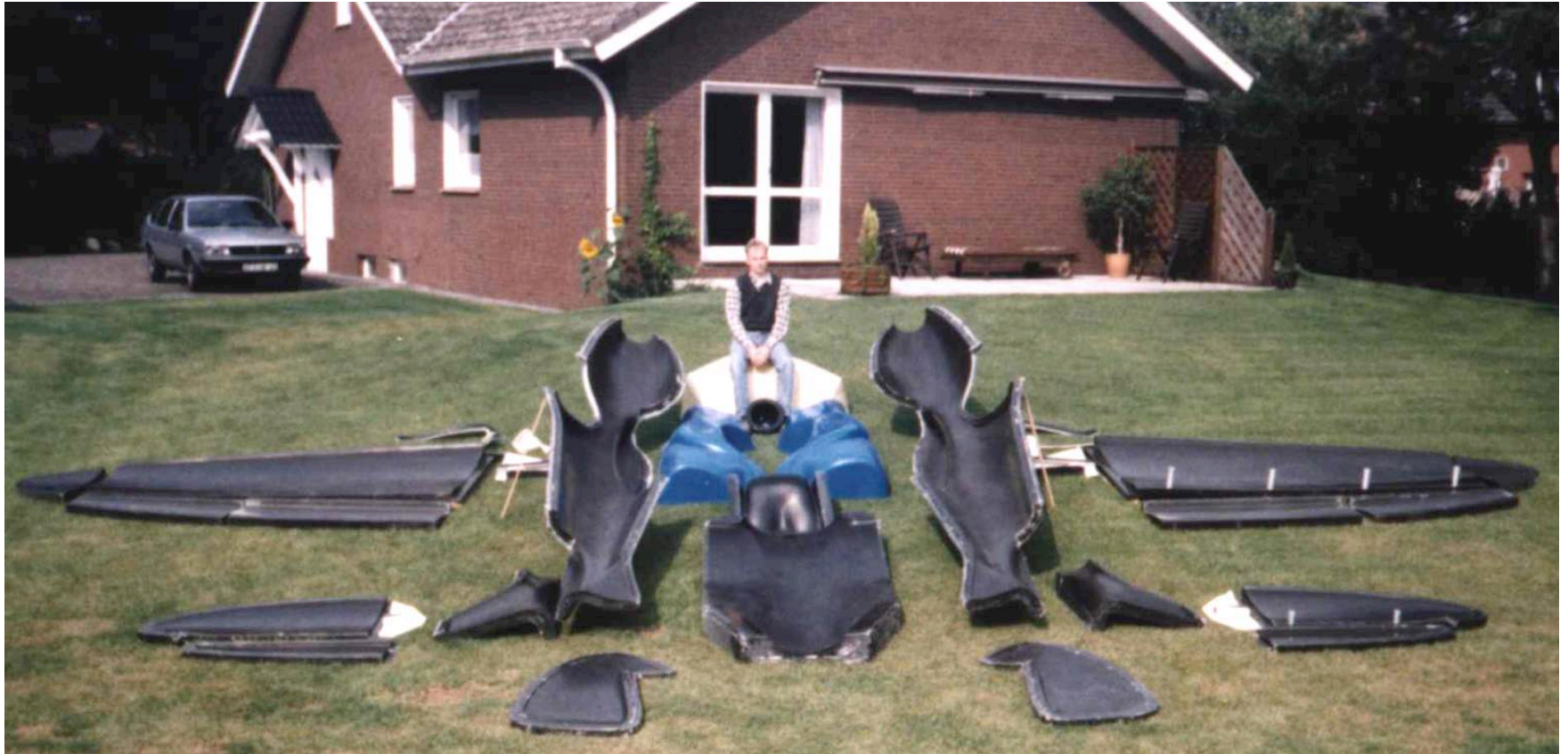
Formensatz für die Strukturbauteile des Ultraleichtflugzeuges Silence
