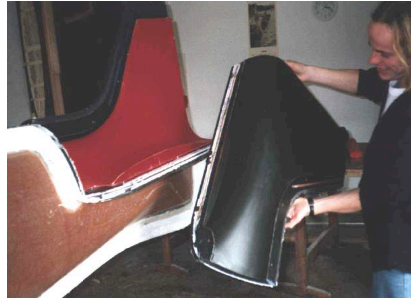
Öffnen der Formen nach dem Aushärten
