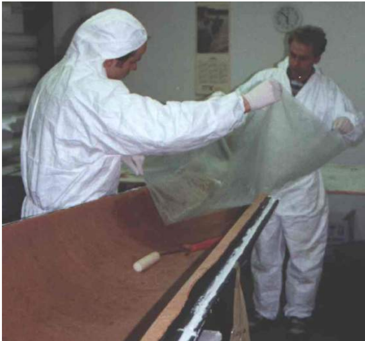
Einlegen des vorgetränkten inneren Decklaminates
