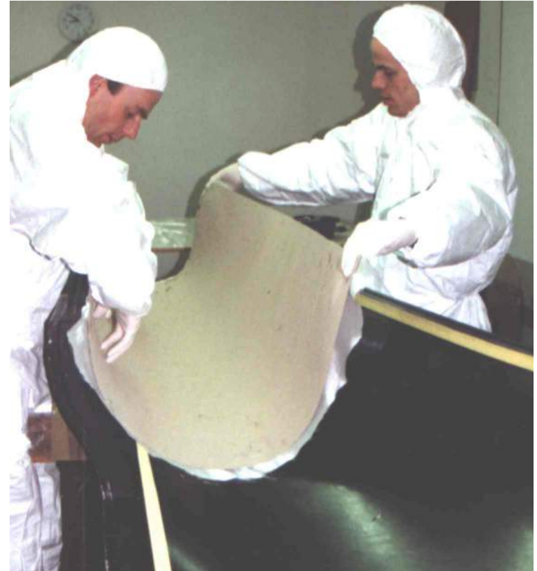
Einlegen der zugeschnittenen Gewebestücke
