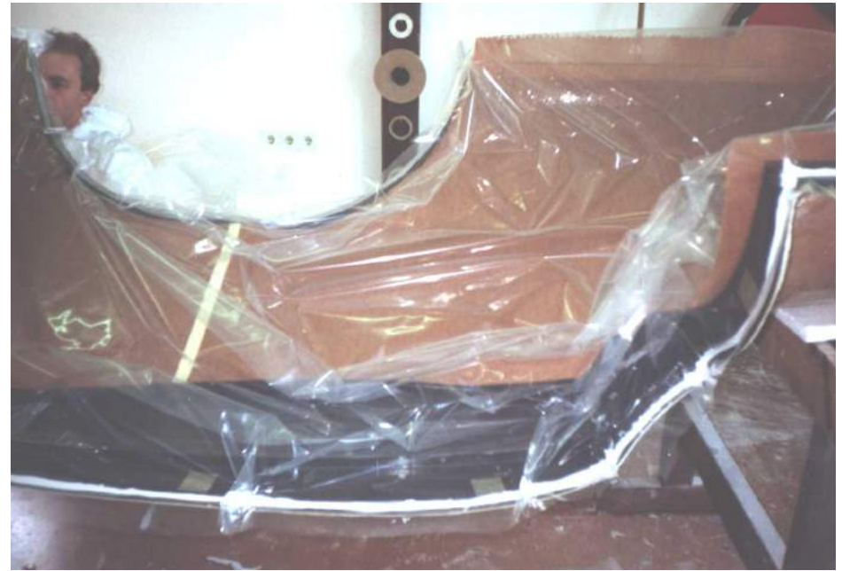
Verpressen von Decklage und Wabenkern im Vakuum
