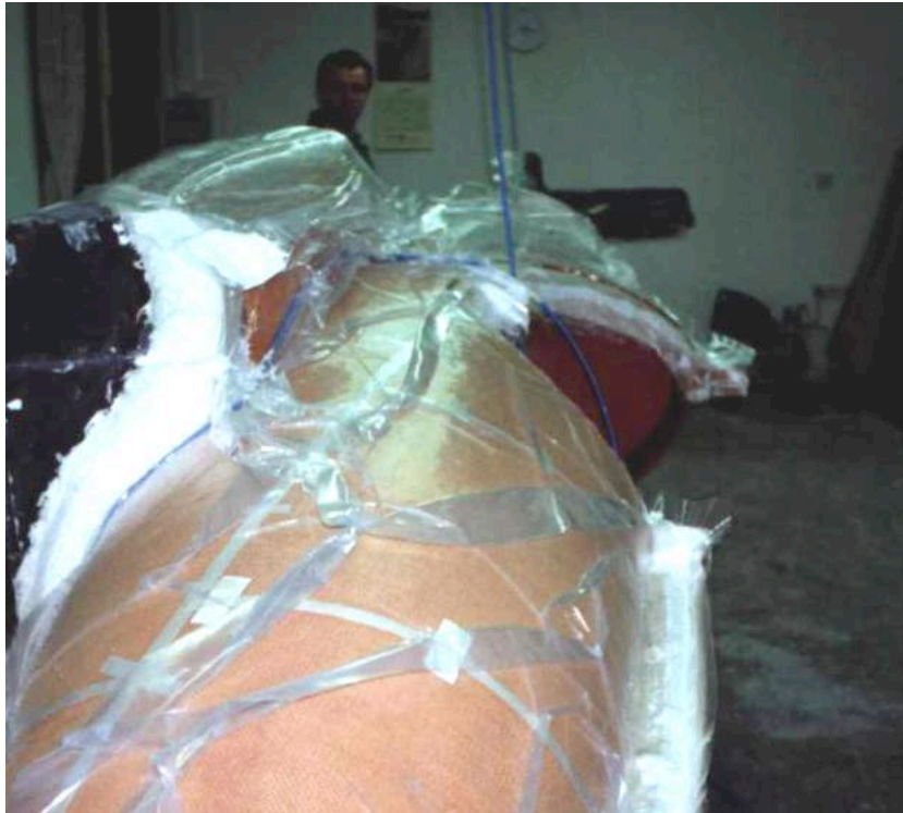
Verpressen der Formen im Vakuumsackverfahren
