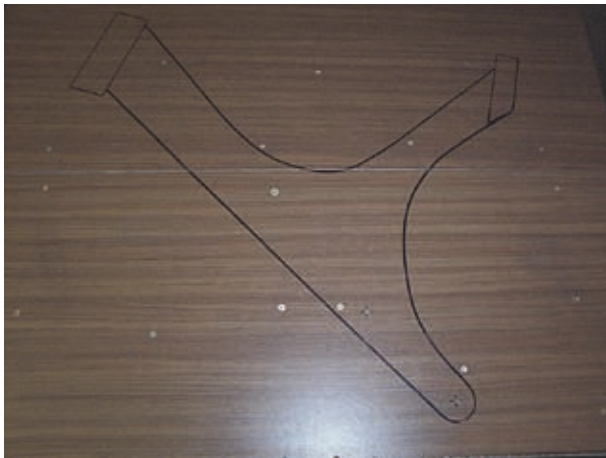
(Bild 41 Angerissenes Trennbrett)
