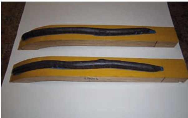
(Bild 18a Kerne im Trennbrett seitlich)
