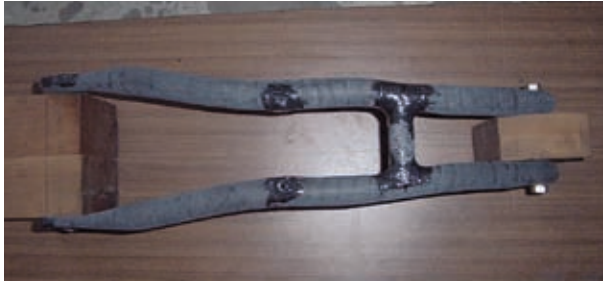
(Bild 28 Verklebung Röhrcchen mit Querholm)
