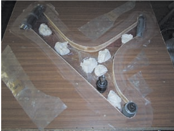
(Bild 44 Gipsbrei im Trennbrett)
