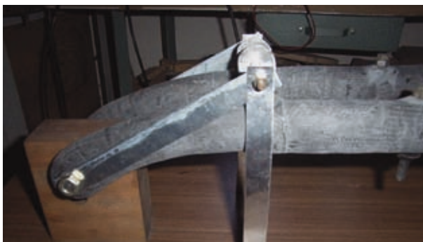
(Bild 30b Fixierung der Federbeinaufnahme seitlich)
