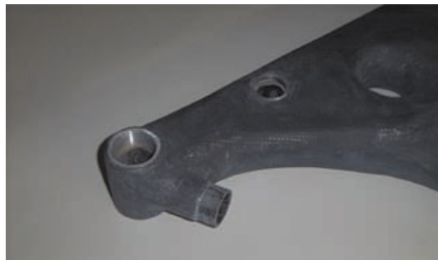
(Bild 54 Verklebte Halterung für Kettenumwerfer)
