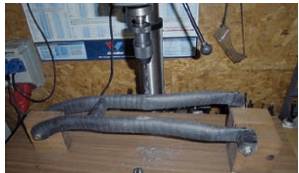
(Bild 26 Bohrungen für Bremsbefestigung)
