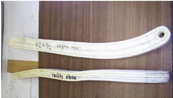
(Bild 10 Schaumstoffholme mit Hilfslinien)
