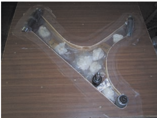
(Bild 44 a Gipsbrei mit Folie abgedeckt)
