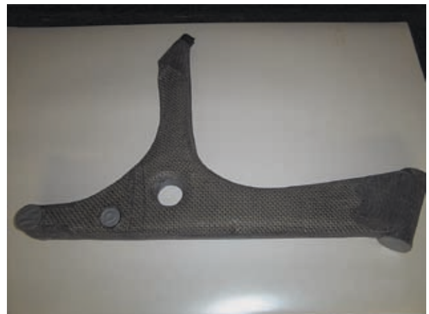
(Bild 49 UD-Lagen um Einlegteile)
