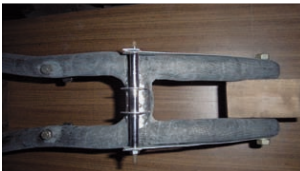
(Bild 30a Fixierung der Federbeinaufnahme von oben)
