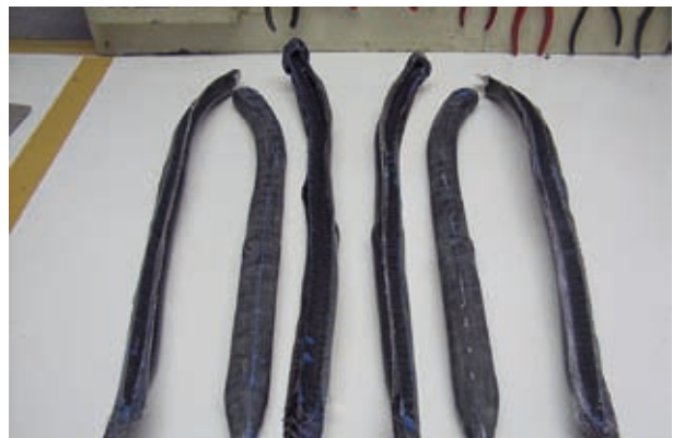
(Bild 19 Halbschalen entformt mit Kern)
