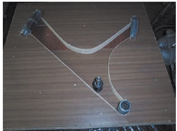
(Bild 43 Vorbereitete Einlegteile im Trennbrett)
