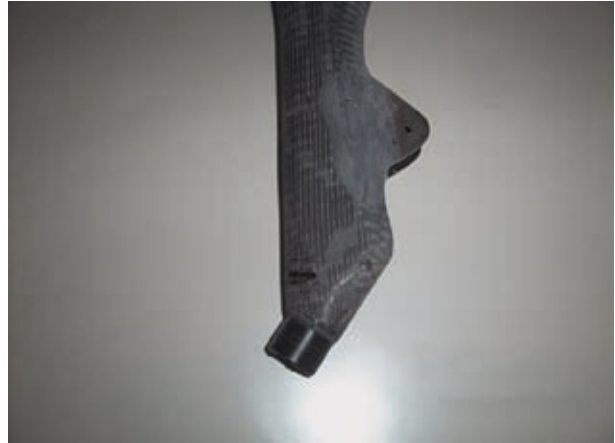
(Bild 53a Verklebung Federbeinaufnahme)
