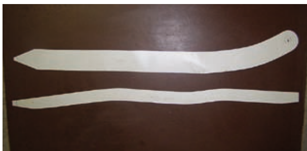
(Bild 08 Kernschablone seitlich und von oben)
