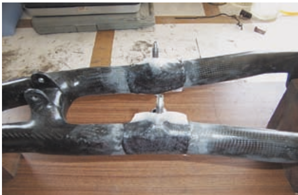
(Bild 58 neue Bremsaufnahme über der Schwinge)
