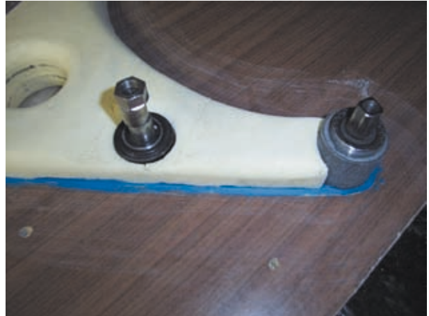
(Bild 45 Fugen mit Modelliermasse)
