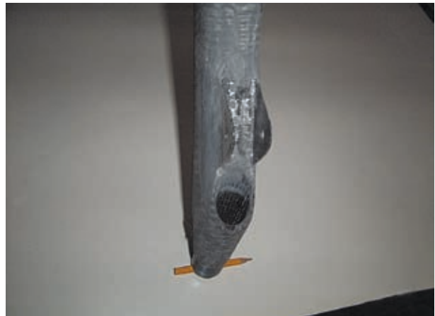
(Bild 53b Verklebung Federbeinaufnahme)
