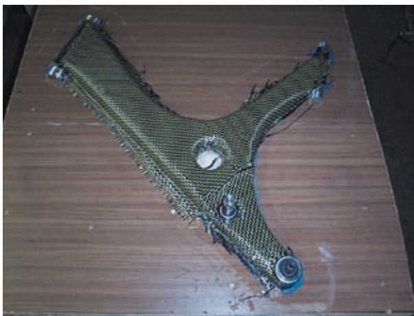
(Bild 47b Kernverstärkung mit Einbindung Einlegteile)
