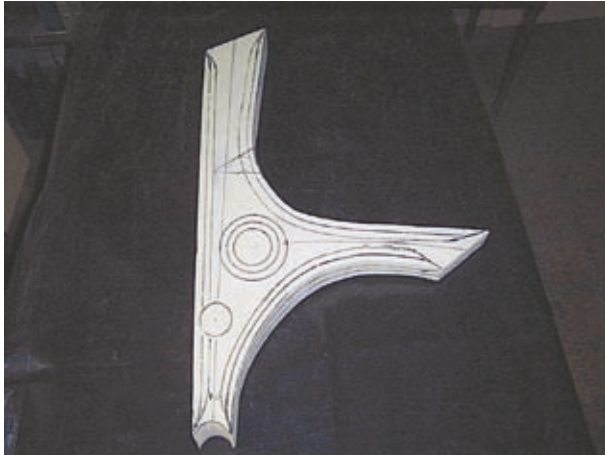
(Bild 37a Rahmenkern mit Hilfslinien)
