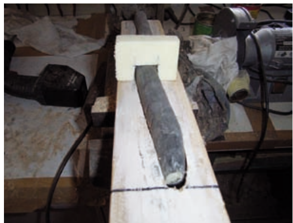
(Bild 16 Höheneinstellung Kern im Trennbrett )
