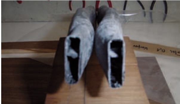
(Bild 23a angepasste Holme von hinten)
