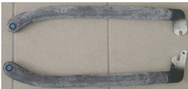
(Bild 24 Einlegeteile mit Holmen verklebt)
