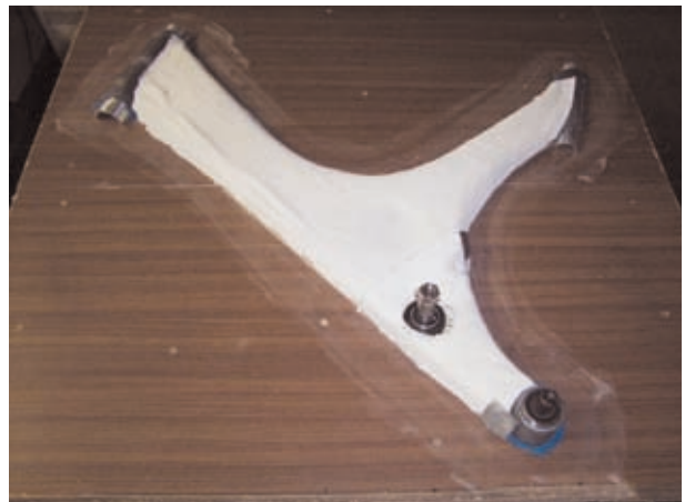
(Bild 46 Schablone für Zuschnitte)
