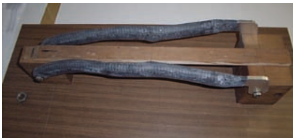
(Bild 23b angepasste Holme in der Lehre)
