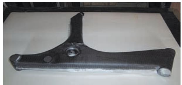
(Bild 50a UD-Lagen mit Abreißgewebe abgedeckt)
