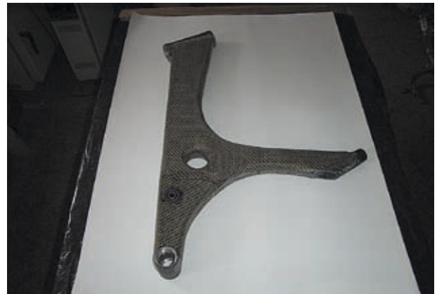
(Bild 48 Kern verstärkt und Einlegteile eingebunden)
