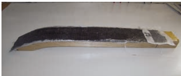
(Bild 21 Quersteg laminiert)
