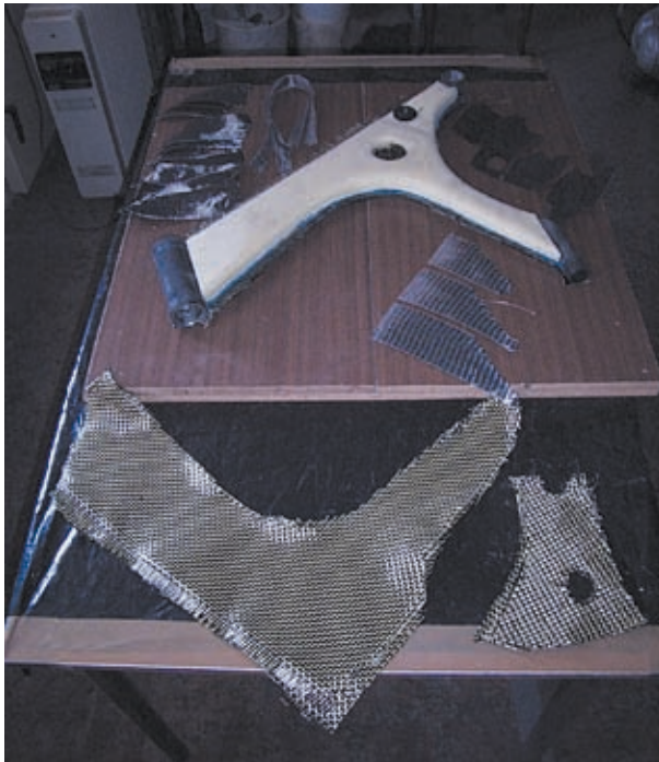
(Bild 47a Zuschnitte Kernverstärkung mit Einbindung Einlegteile)
