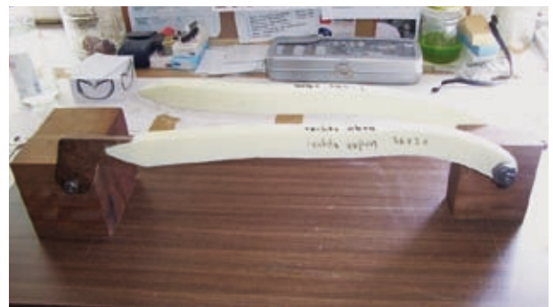
(Bild 09a rechteckige Schaumstoffholme in der Schwingenlehre seitlich)
