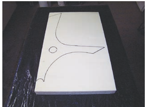
(Bild 35b Anriss der Schaumstoffplatte)
