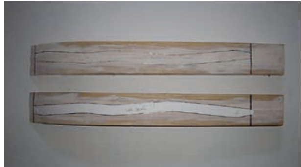
(Bild 15 Trennbrettanriß von oben)
