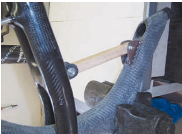
(Bild 52 Fixierung obere Federbeinaufnahme)
