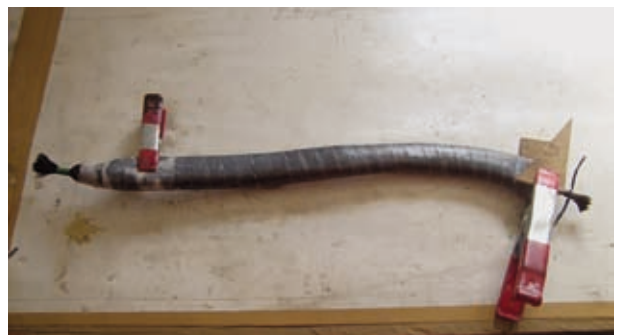
(Bild 22e Holm mit Abrissgewebeband gewickelt)
