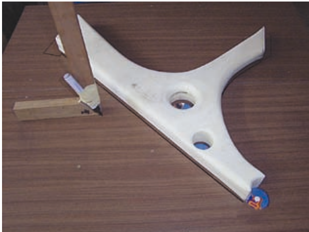
(Bild 40 Kernumriss auf Trennbrett übertragen)
