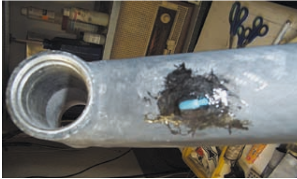
(Bild 55a Widerlager für Bowdenzug verklebt)
