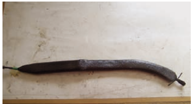
(Bild 22d Holm mit einer Lage Kohleschlauch verstärkt)
