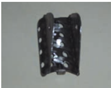
(Bild 51 Blechteil obere Federbeinaufnahme)
