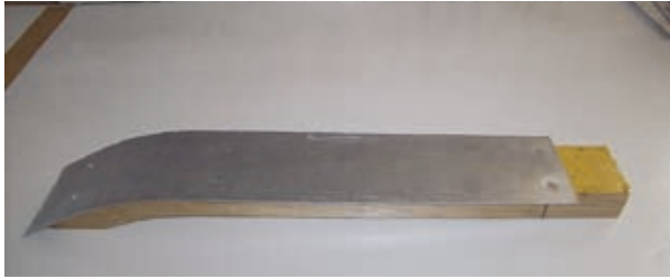
(Bild 20 aus Trennbrett wird Form für Quersteg)
