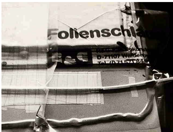
Foto 21: Der Wabenkern wird unter Vakuum verpreßt
