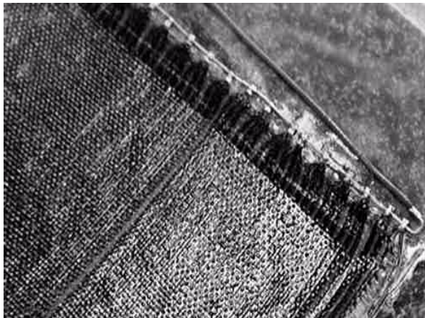
Foto 44: Das laminierte Heizgewebe
