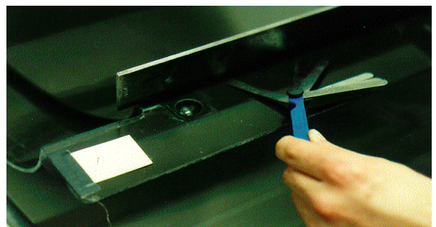
Foto 76: Messung des Verzugs am Formenrand
