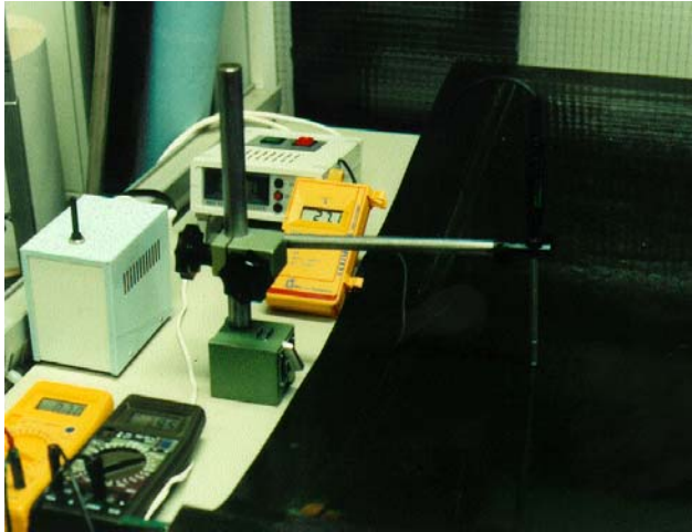
Foto 77: Temperaturmessung an der Formenscha- le
