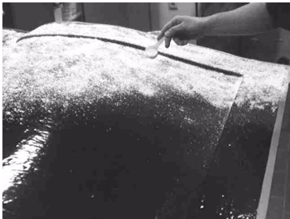
Foto 33: Abstreuen mit Glasmehl, - schnitzeln und Baumwollflocken
