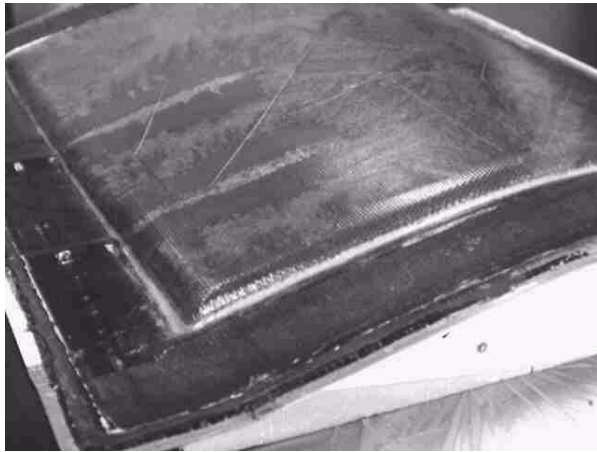
Foto 67: Die fertige obere Formenschale
