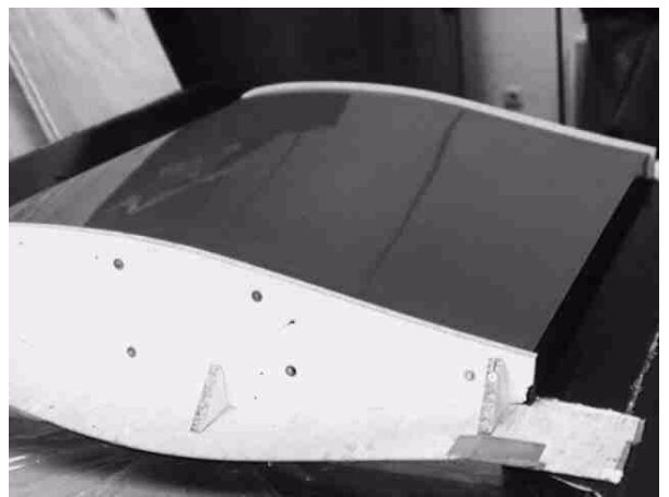
Foto 72: Vor dem Anbau der seitliche Trennbretter
