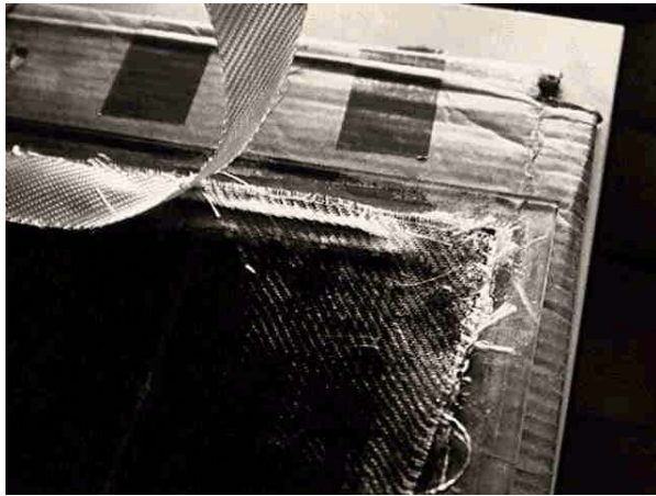
Foto 14: Zusätzliche Isolation an den Lötstellen
