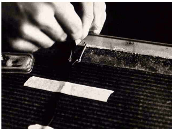
Foto 15: Stromführung und Anschluß der Temperaturfühler
