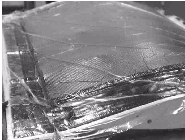
Foto 62: Der Wabenkern wird unter Vakuum verklebt
