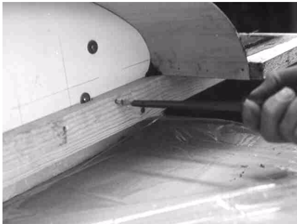
Foto 68: Das Trennbrett wird abgenommen
