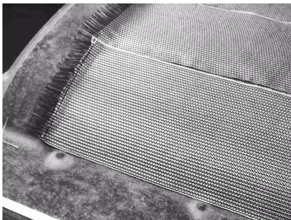
Foto 39: Das aufgelegte Heizgewebe
