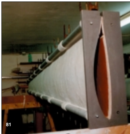
Bild 79 Verstärkungsteile für die spätere Anlenkung der Querruder-Wölbklappe.
