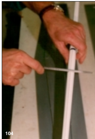
Bild 104 Mit einer Feile werden die Durchgänge für die Scharniere eingearbeitet.
