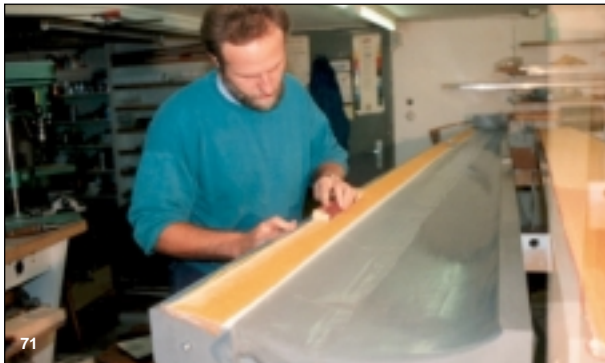
Bild 71 Ausschleifen der Endkante Oberseite-Querruder.
