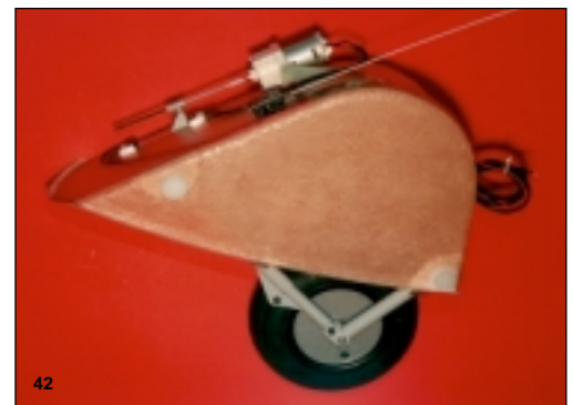
Bild 42 Das Ein- und Ausfahren erfolgt über eine Gewindestpindel mit Elektromotor und Endabschaltung.
