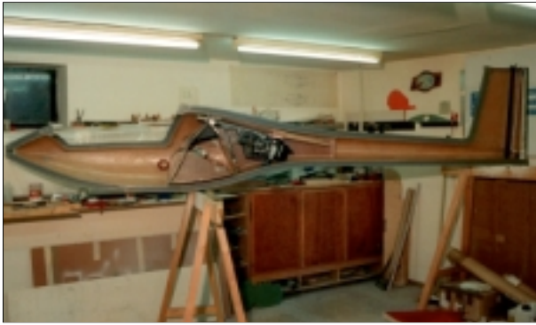
Bild 47 Nun ist alles bereit zum Verkleben der Schalen.
