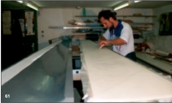
Bild 61 Einlaminieren von 2 Lagen 80g-Glasgewebe in Diagonalrichtung ( \pm 45^\circ zur Nasenleiste).
