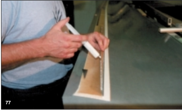
Bild 77 ...und mit Glass-Bubbles aufgeklebt.
