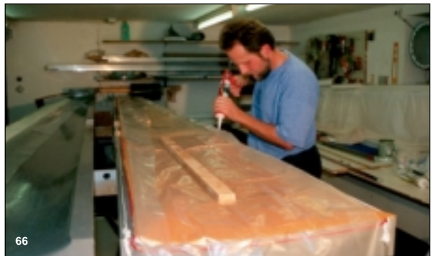
Bild 66 Auflegen der Vakuum-Folie und Abdichten mit Silicon.
