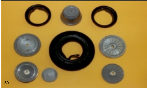
Bild 39 Der Reifen 7x1 3/4 Zoll mit Schlauch, sowie allen Felgenteilen und den erforderlichen Formen.
