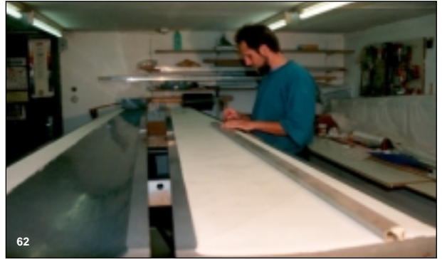
Bild 62 Anzeichnen des Querruderdrehpunkts.
