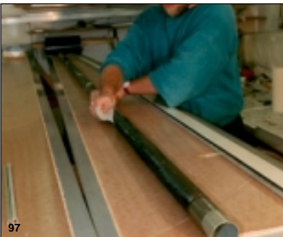
Bild 95 Die Styroporelemente werden aneinandergelebt und umseitig mit ca. 12 Kohlerovings belegt.
