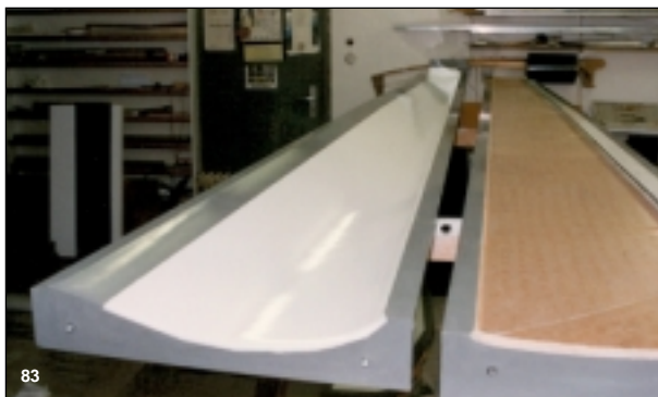
Bild 83 Ist das Querruder entformt, kann die Deckschicht für die Oberseite der Fläche eingespritzt werden.
