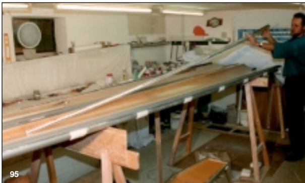
Bild 95 Die Styroporelemente werden aneinandergelebt und umseitig mit ca. 12 Kohlerovings belegt.
