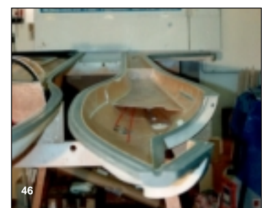
Bild 46 Im nächsten Arbeitsschritt werden die Einbauten in die Rumpfhalschalen eingeklebt.
