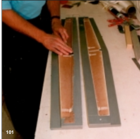
Bild 101 Das Bündigschneiden nach dem Trocknen der Innenlage.
