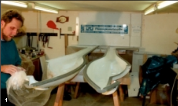
Bild 1 Gründliches Wachsen der Formen und Abdecken des Formenrandes mit Folie bis ca. 2 mm an die Kante. Anschließend Einspritzen der Deckschicht (UP-Vorgelat weiß) oder 2-K-Lack. Gewicht ca. 300 g/m 2 .
