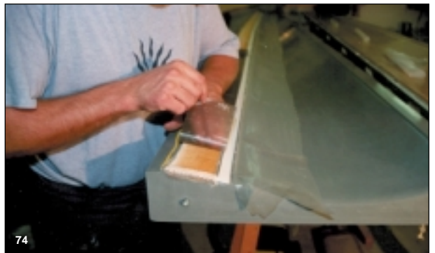
Bild 74 Anschließend wird eine Lage 80g-Glasgewebe aufgelegt und im Vakuum verpreßt.
