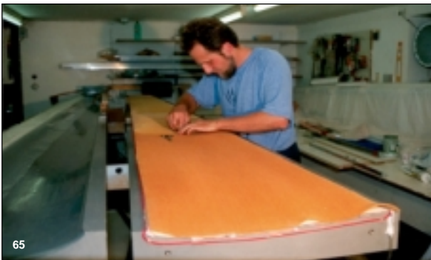
Bild 65 Die Wabenzuschnitte werden eingelegt und an den Stößen mit Tesa fixiert.
