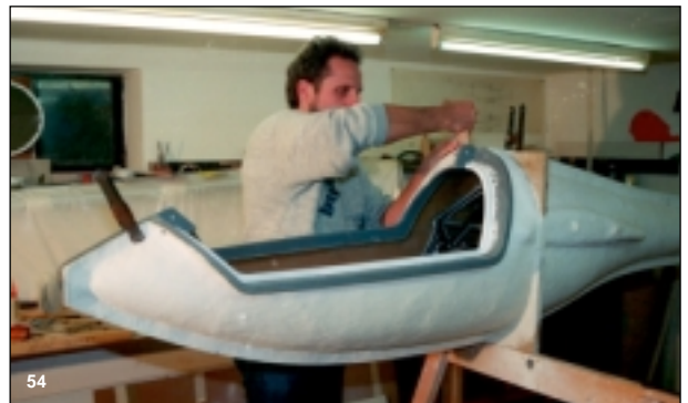
Bild 54 Nach 24 h Härtung ist der Zeitpunkt zum Entformen gekommen. Vorsichtig wird die Form mit Holzkeilen auseinandergedrückt.
