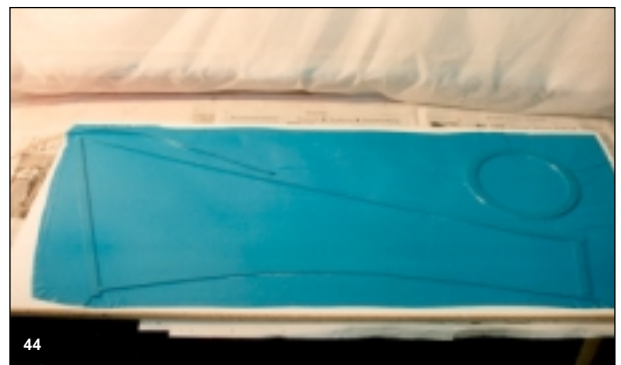
Bild 44 Nach Papierschablonen werden Leisten für den Klappentriebwerksschacht, bestehend aus Spant und Trennwand, auf eine Spanplatte geklebt und mit Vakuum eine Folie darüber gezogen.
