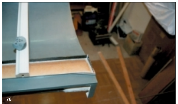
Bild 76, 77 Die Holme werden aus einer beidseitig mit 93 g-Kohle beschichteten Wabenplatte ausgeschnitten...
