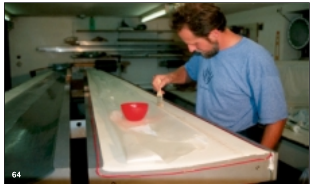
Bild 64 Im Querruderdrehpunkt wird ein ca. 2 cm breites Abreißgewebe einlaminiert.
