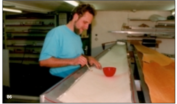
Bild 86 Einlaminiieren einer Kupplungsschicht aus 80 g-Gewebe.
