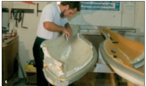
Bild 6 Die zugeschnittene Wabenplatte wird entnommen und eine weitere Lage 80g-Glasgewebe einlaminert. In das noch nasse Gewebe wird die Wabe eingelegt, mit Gewichten beschwert und an den Stößen mit Tesa fixiert.
