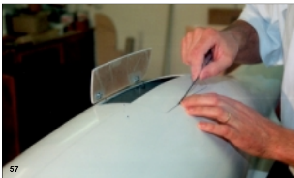
Bild 57 Das Ausschneiden der Fahrwerksklappen mit einem feinen Sägeblatt.
