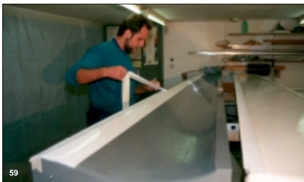
Bild 59 Nach dem Wachsen wird die Deckschicht in die obere und untere Formenhälfte eingespritzt (Oberseite nur im Querruderbereich).
