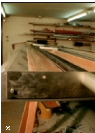
Bild 99 In diese Nuten werden Holmstege mit Glass-Bubbles eingeleimt, auf die dann der eigentliche Holm geklebt wird. Dies ergibt eine sehr geringe Klebefläche zur Flächenschale und damit einen großen Gewichtsvorteil.
