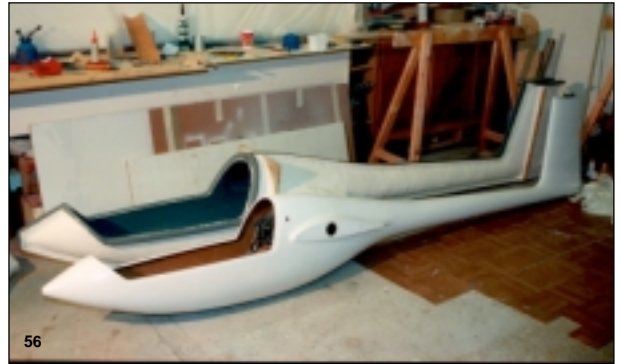
Bild 56 Geschafft! Das Gesamtgewicht des Rumpfes beträgt 8,5 kg, davon abzuziehen sind 4,5 kg für das Klapptriebwerk und 1,5 kg für Einziehfahrwerk und Spant. Es bleibt ein Schalengewicht von 2,5 kg für einen Rumpf mit ca. 2,5 m 2 Fläche.
