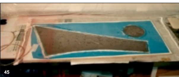
Bild 45 In dieser einfachen Form wird eine 3 mm Wabe im Vakuum beidseitig mit 2 Lagen Glasgewebe 80 g/m 2 beschichtet.
