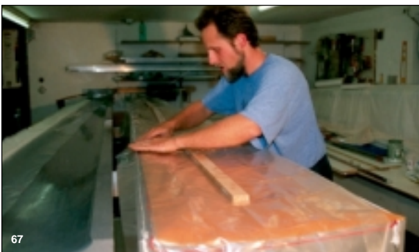
Bild 67 Andrücken der Vakuumfolie.
