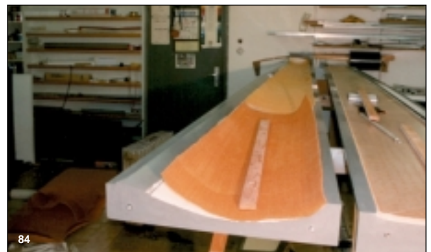
Bild 84 Einlaminieren von zwei Außenlagen 80g-Gewebe.
