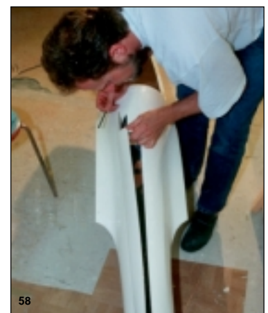
Bild 56 Geschafft! Das Gesamtgewicht des Rumpfes beträgt 8,5 kg, davon abzuziehen sind 4,5 kg für das Klapptriebwerk und 1,5 kg für Einziehfahrwerk und Spant. Es bleibt ein Schalengewicht von 2,5 kg für einen Rumpf mit ca. 2,5 m 2 Fläche.
