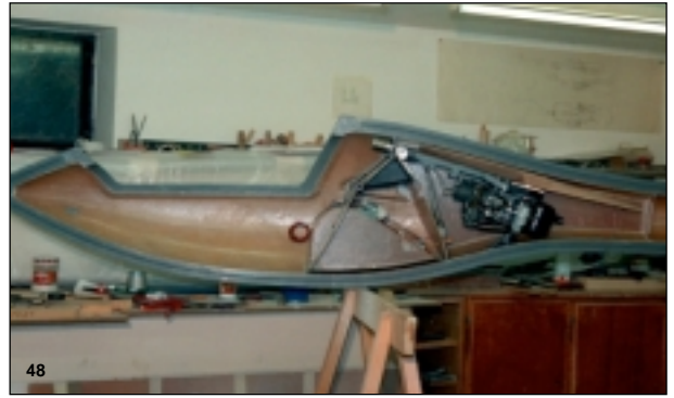
Bild 48 Zu sehen ist das Einziehfahrwerk, der Hauptspant, das Klapptriebwerk...
