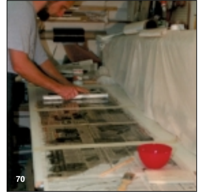
Bild 70 Mit den Papierzuschnitten wird das Gewebe auf Zeitungspapier aufgelegt und getränkt.
