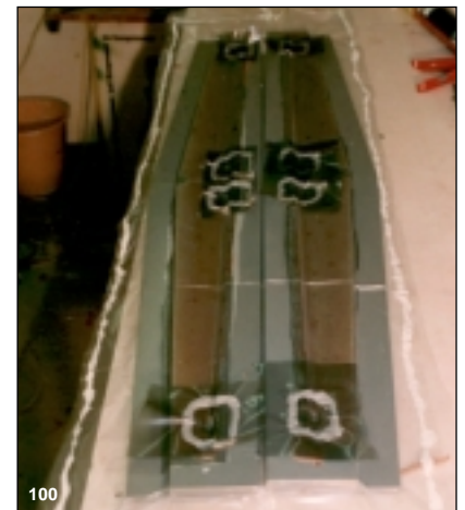
Bild 100 Die Herstellung der Höhenruderflaps erfolgt nach dem gleichen Schema wie die Tragflächen (Deckschicht, Außenlaminat, Kupplungslage, Wabe, Innenlaminat).
