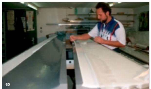
Bild 60 Auffüllen der Nasenleiste mit einem Harz/Microballons-Gemisch.
