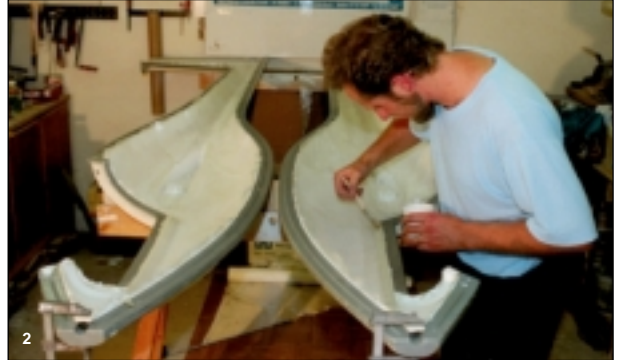
Bild 2 Abziehen der Folienabdeckung im noch nassen Zustand. Danach Aushärten der Deckschicht über Nacht. Die Kanten im Kabinenhaubensbereich werden mit einem Harz-Baumwollflocken-Glasfaserschnitzel-Gemisch aufgefüllt.
