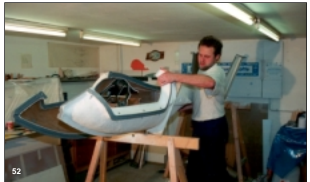
Bild 52 Die beiden Formhälften werden aufgestellt und vorsichtig zusammengeschoben.
