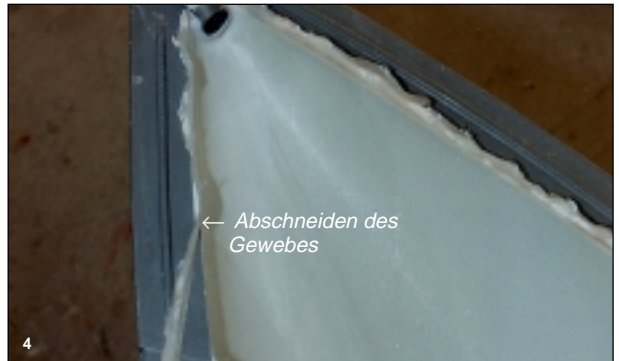
Bild 4 Nach dem Anhängen des Harzes (ca. 8 h Härtezeit) wird das überstehende Gewebe mit einer scharfen Klinge abgeschnitten.
