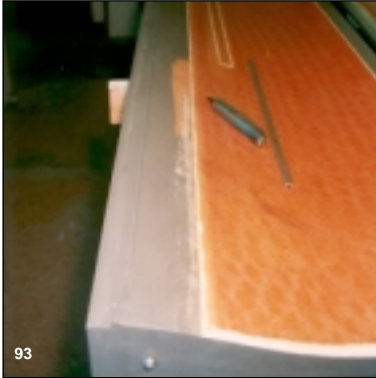
Bild 93 Nach Unterschieben von 0,4 mm Sperrholz wird die Endkante der Fläche besäumt.
