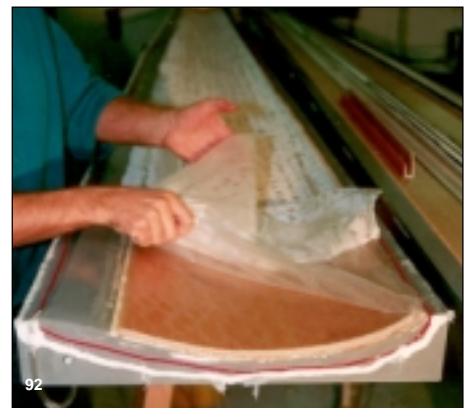
Bild 92 Entfernen des Vakuums, der Wachsschnur und des Silikons.
