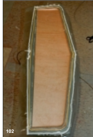
Bild 102 Die Höhenruderdämpfungsflosse beim Einpressen der Wabe.
