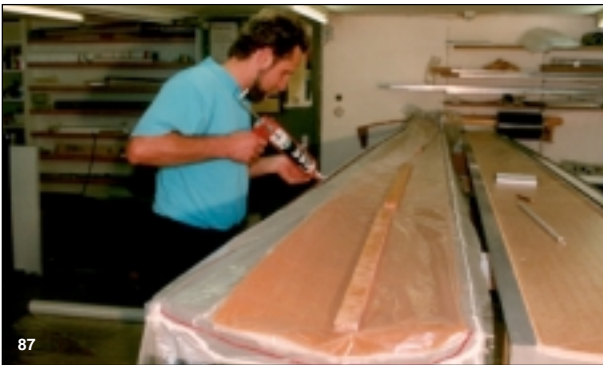
Bild 87 Einlegen der Wabe und anschließendes Vakuumieren der Form.
