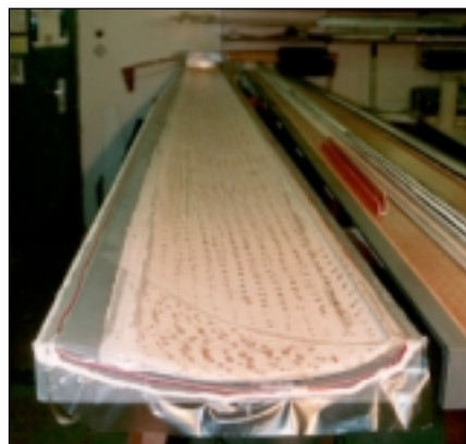
Bild 91 Die Innenlage wird einlaminiert und im Vakuum verpreßt. Zur besseren Absaugung wird zwischen Übertragungsfolie und Vakuumfolie ein Abreißgewebe durchgehend eingelegt. Überschüssiges Harz wird durch die gelochte Übertragungsfolie vom Abreißgewebe aufgesaugt.
