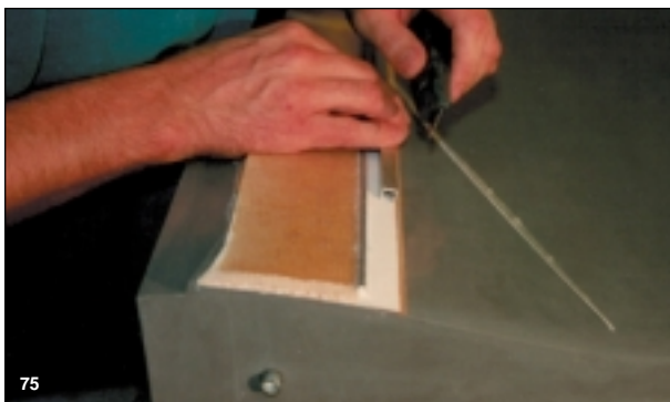
Bild 75 Beschneiden der Dichtlippe nach dem Trocknen.
