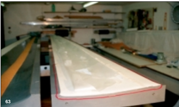
Bild 63 Einlaminieren der "Kupplungslage" 80 g Glasgewebe.
