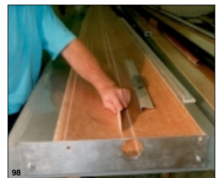
Bild 98 In die Flächenoberschale werden mit einem Schleifholz bis zur Außenhaut drei Nuten für die Holme eingeschleift.
