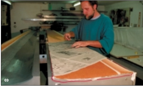
Bild 69 Papierzuschnitte für die Innenlage werden vorbereitet.
