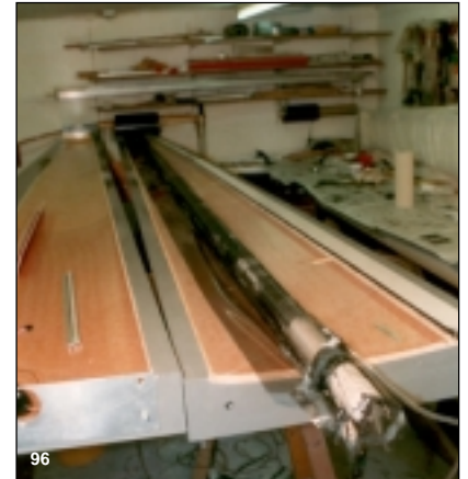
Bild 96 Nach dem Aushärten ist die ganze Einheit fest genug, um mit zwei Lagen Kohlegewebe beschichtet zu werden. Anschließend wird im Vakuumsack gepreßt.
