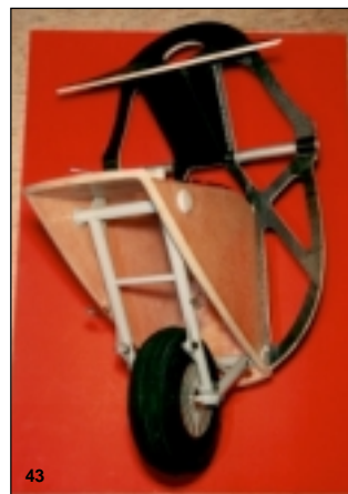
Bild 43 das Fahrwerk im ausgefahrenen Zustand, bereits mit dem Hauptspant verklebt.
