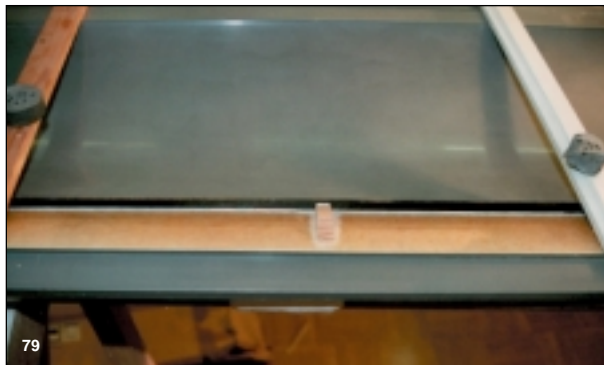
Bild 79 Verstärkungsteile für die spätere Anlenkung der Querruder-Wölbklappe.
