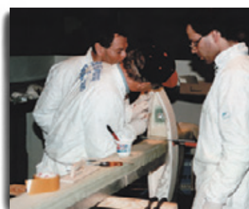
Handlaminat Verkleben von Tragflächenrippen auf einen Holm aus GFK (Flugzeugbau-Workshop der Aero-Luftfahrtmesse, Friedrichshafen).
