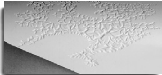
Elefantenhaut in einer Polyesterdeckschicht.
