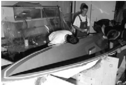
Negativ-Form aus Epoxydharz/Laminierkeramik
