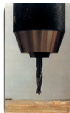
Bohren von Twaron® (Aramid)-Laminaten mit einem Hartmetallbohrer mit spezieller „Sichel-Schneide“
