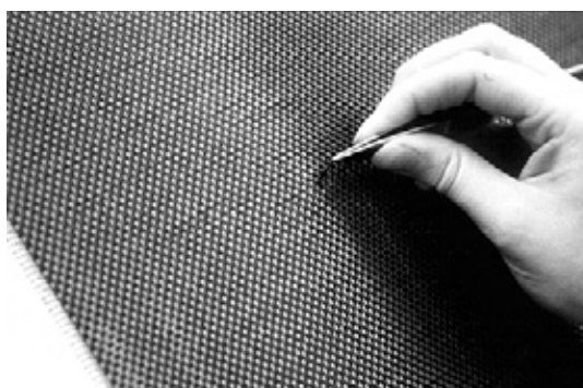
Ein Filamentbruchstück wird mit der Pinzette entfernt. Die Endkontrolle erfordert viel Feingefühl und Erfahrung. Keine Fehlstelle darf übersehen werden.
