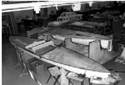
Die fertige Bootsschale wird mit dem Deck verklebt
