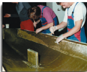
Handlaminat Tränken eines Kohle/Aramid-Gewebes mit Epoxydharz für einen Segelflugzeugrumpf.
