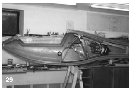
Einziehfahrwerk, Hauptspant und Klapptriebwerk nach dem Einbau.
