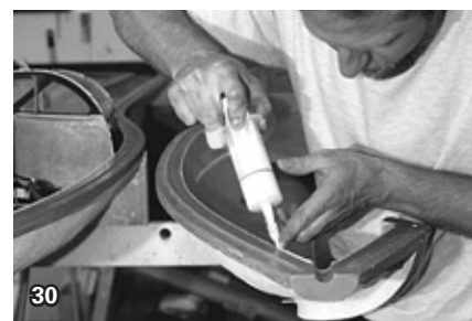
Zum Verkleben der Rumpfhälften wird eine Raupe aus einem Harz/Glas-Bubbles-Gemisch beidseitig auf die Klebestellen aufgetragen.
