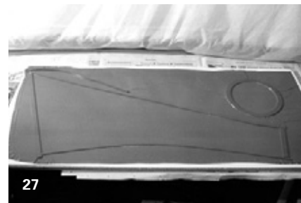
Nach Papierschablonen werden Leisten für den Klapptriebwerksschacht, bestehend aus Spant und Trennwand, auf eine Spanplatte geklebt und mit Vakuum eine Folie darüber gezogen.
