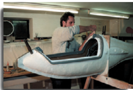
Zweiteilige Negativform mit Epoxyd-Deckschicht (Formenharz P) und einem tragenden Laminat aus Hartschalengips (R&G Laminierkeramik)
