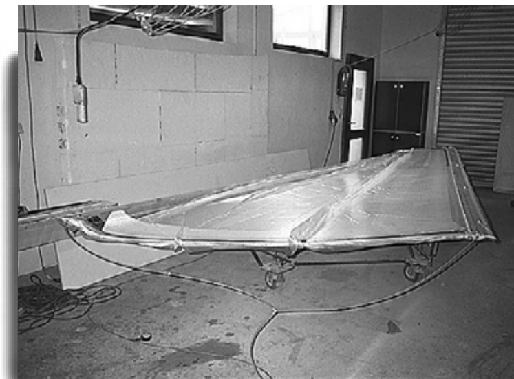
Vakuumgezogene Form eines UL-Tragflügels. Auf der 9 m 2 großen Form wirkt eine Anpreßkraft von insgesamt 45 Tonnen.
