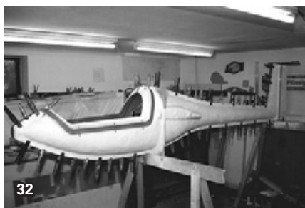
Klammern pressen die geschlossene Form zusammen.
