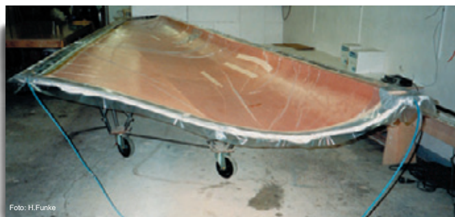
Flügelhälfte eines UL-Flugzeuges im Vakuum Skin of a microlight wing in vacuum
