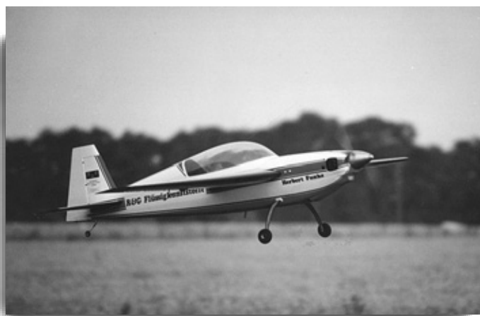
Das F3A-X Kunstflugmodell ist komplett in Wabensandwichbauweise aufgebaut. Mit Deckschichten aus 49 g/m 2 -Glasgewebe und einem 2 mm Wabenkern wird eine hohe Steifigkeit bei geringstem Gewicht erzielt.
