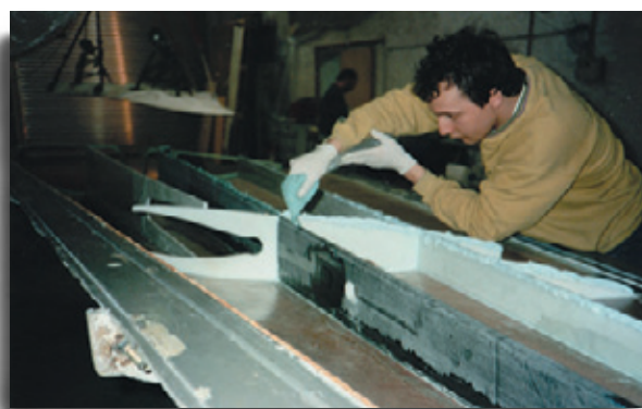
Aufbringen eines gefüllten Epoxydharzes zum Verkleben der Tragflächen-Halbschalen
