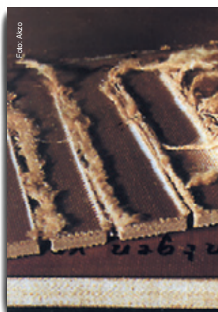
Unsaubere Schnittkanten im Vergleich zu einer sauberen Kantenbearbeitung von Twaron® (Aramid)-Laminaten
