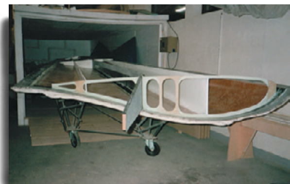
Holm und Flächenschale eines UL-Nurflüglers
