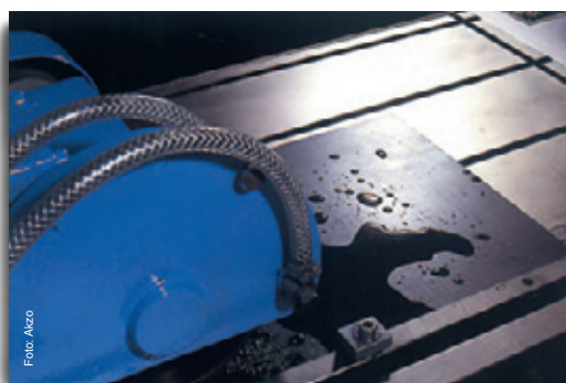
Sägen eines Tenax® (Kohlenstoff-Faser)-Laminats mit einer Präzisionsäge
