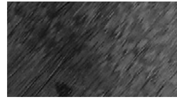
Vollkommen flach liegendes Kohle-Biaxial-Gelege Biaxial carbon inlay lying perfectly flat.
