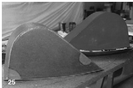
Der fertige Fahrwerkskasten lässt sich leicht entformen.
