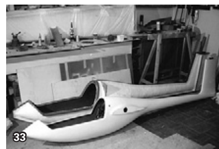
Nach 24h Härtung wird der Rumpf entformt. Das Gesamtgewicht beträgt 8,5 kg davon abzuziehen sind 4,5 kg für das Klapptriebwerk und 1,5 kg für Einziehfahrwerk und Spant. Es bleibt ein Schalengewicht von 2,5 kg für einen Rumpf mit ca. 2,5 m 2 Fläche.
