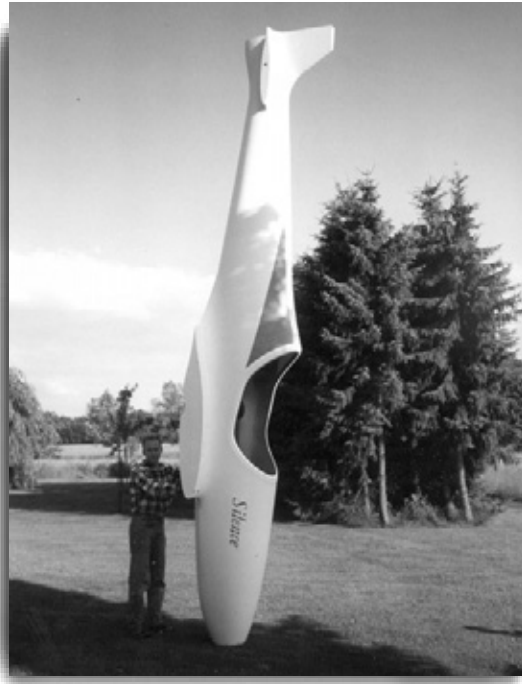
Flugzeugrumpf in Waben-Sandwichbauweise
