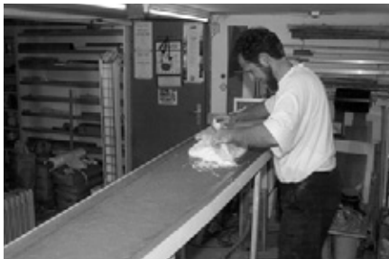
Auf das nasse Epoxydharz/Glasgewebelaminat wird mit Laminierkeramik vorgetränktes M 1-Glasgewebe aufgelegt
