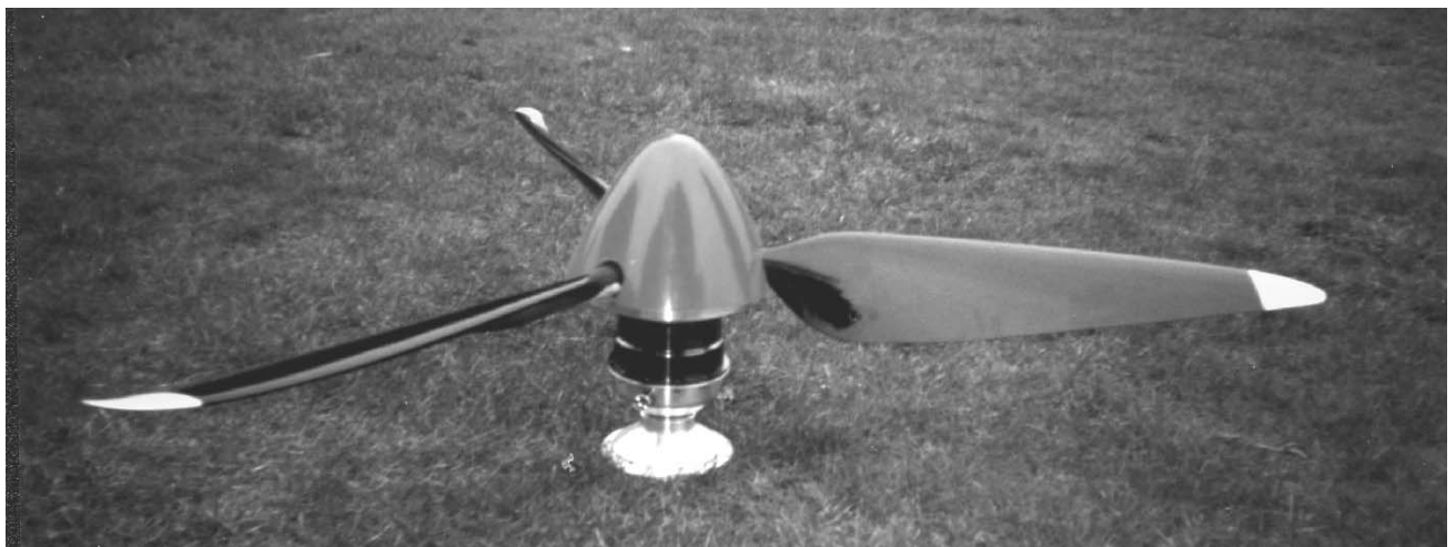
Bild 5.40: Verstellpropeller mit angeflanschtem Planetengetriebe
