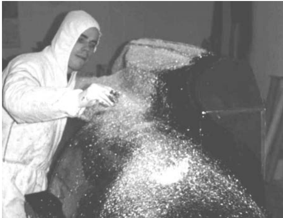
Bild 5.65: Einstreuen von Kurzglasfasern in die Formendeckschicht
