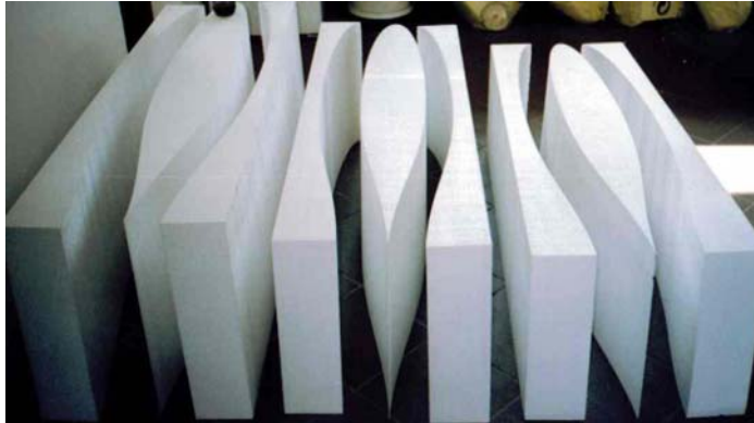
Bild 5.53: Segmente des Tragflügelurmodells
