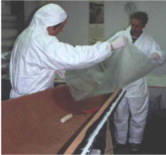
Bild 5.75: Einlegen des vorgetränkten inneren Decklaminates
