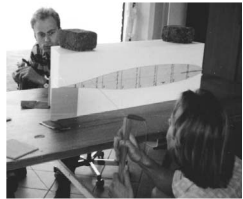
Bild 5.52: Zuschneiden einzelner Segmente über Schablonen
