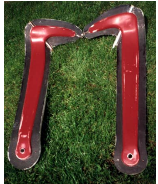
Bild 5.27: Urmotive der Fahrwerksschwinge beim Abformen
