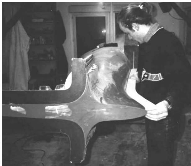
Bild 5.63: Anpassen des Trennbretts an das Rumpf-Urmodell
