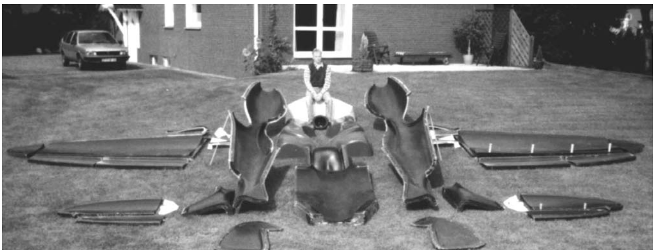
Bild 5.69: Negativformen für das UL-Flugzeug Silence
