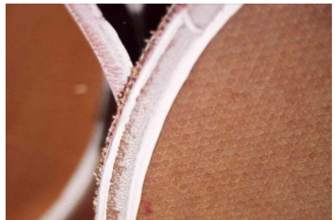
Bild 3.13: Verteilung der Dichtmasse in der Dichtfuge
