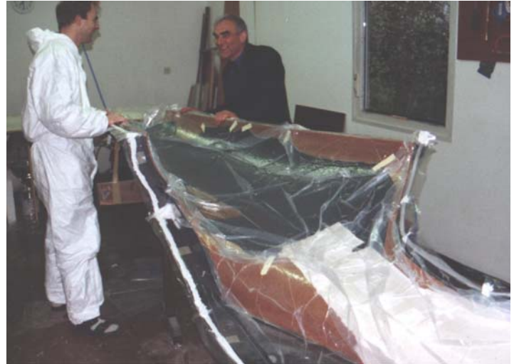
Bild 2.46: Vakuumpressen am Beispiel einer Rumpfhalschale
