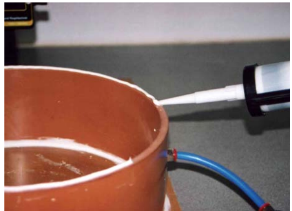
Bild 3.11: Auftragen der Dichtmasse
