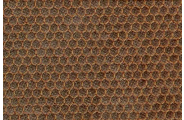
Bild 3.9: Wabenkern mit GFK-Deckhaut
