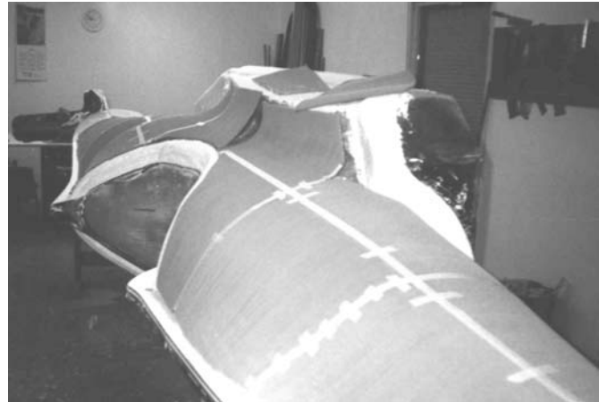
Bild 5.66: Wabenkernzuschnitte vor dem Verpressen mit der Rumpfform
