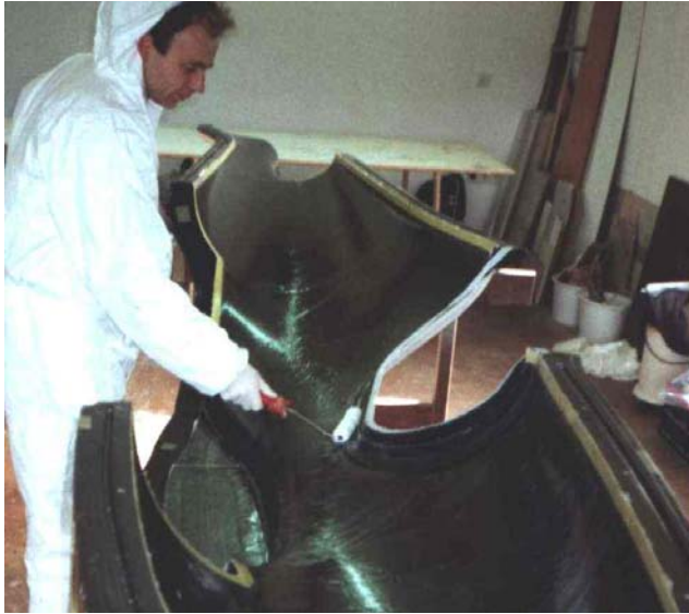
Bild 5.71: Ausrollen der Form mit Laminierharz
