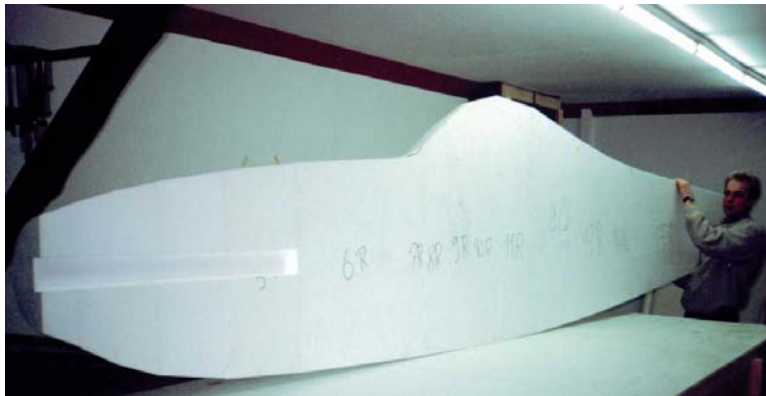
Bild 5.56: Segmentweiser Aufbau des Rumpfkerns in zwei Hälften
