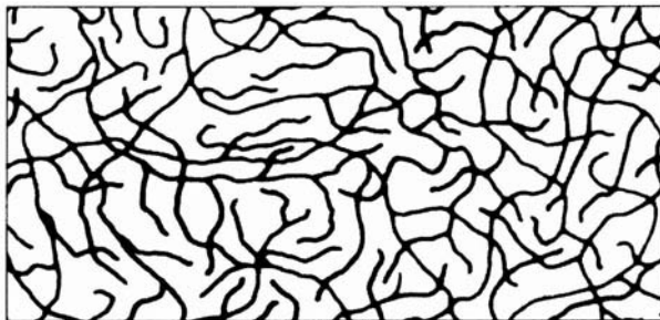
Bild 2.7: Strukturmodell Thermoplaste [Gnauck, Fründt 91]
