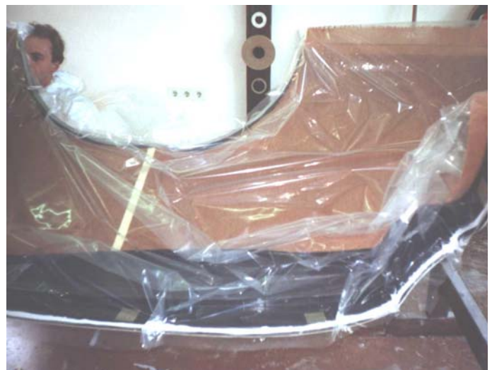
Bild 5.74: Rumpfform mit eingelegtem Wabenkern und Vakuumfolie vor dem Absaugen
