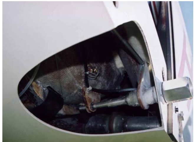
Bild 5.8: Anbindung der Steuerungselemente an die Rumpfstuktur
