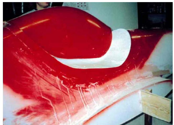
Bild 5.59: Heraustrennen des Kabinenhaubenausschnittes
