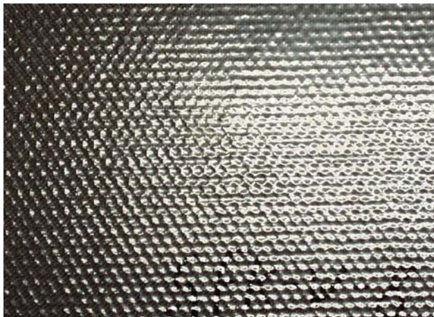
Bild 3.25: Telegraphing - optisches Abzeichnen der Wabekernstruktur durch die Deckhäute
