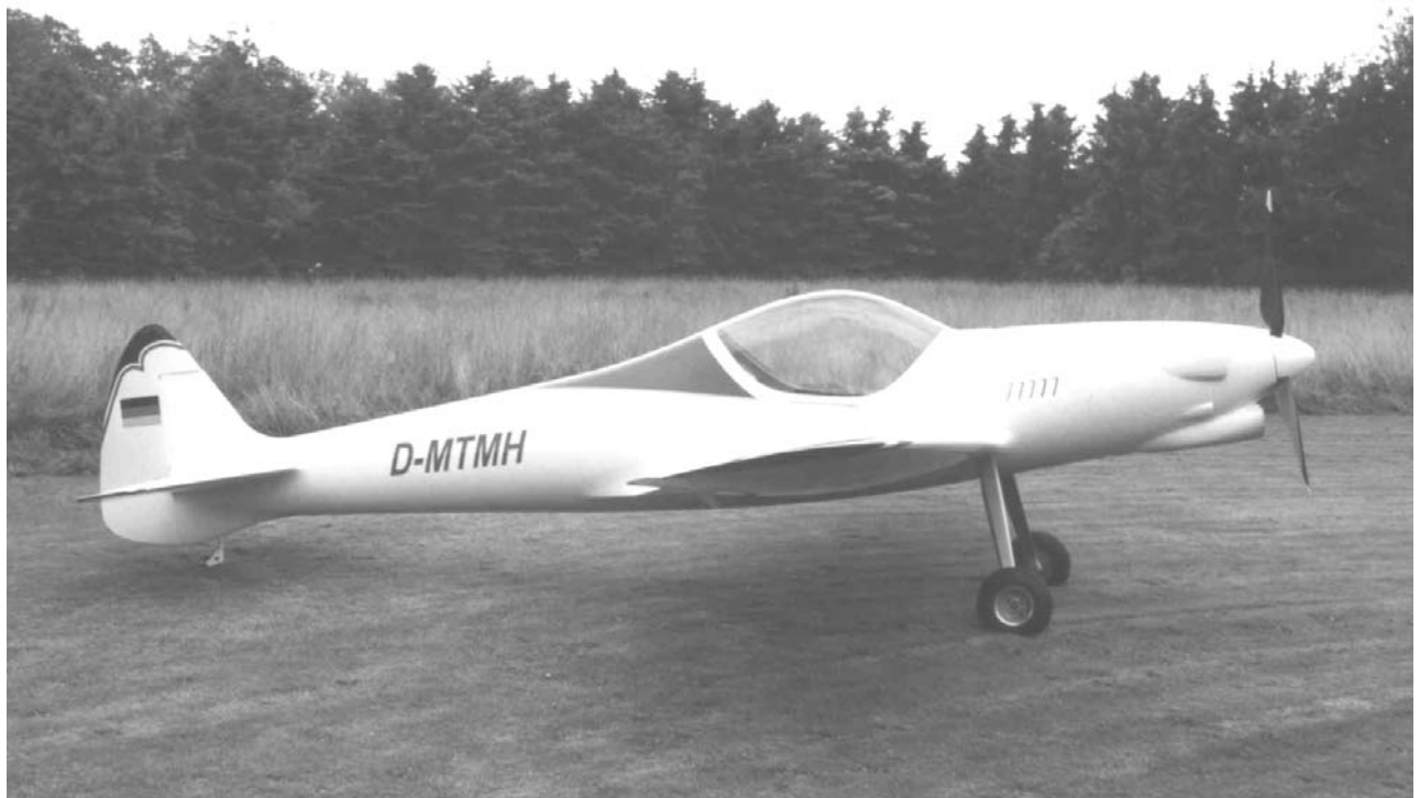
Bild 5.81: Das Ultraleichtflugzeug Silence in Faserverbund-Wabensandwichbauweise
