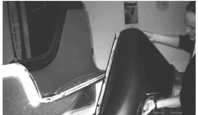
Bild 5.68: Öffnen der Rumpfform
