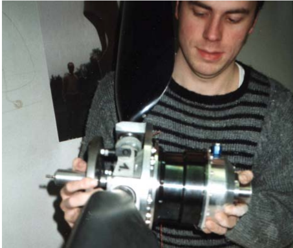
Bild 5.32: Planetengetriebe mit Verstellpropeller
