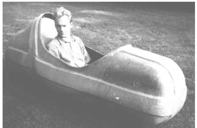
Bild 5.79: Monocoque mit Längsverstärkungen in Doppelwabensandwichbauweise
