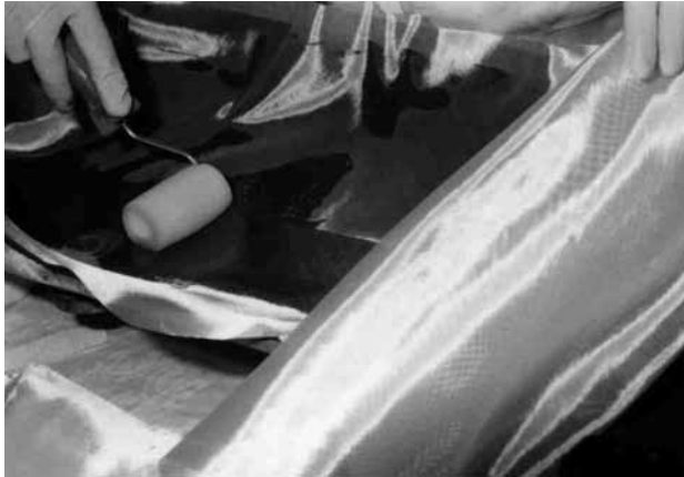
Bild 50: Anschließend wird die erste Gewebelage eingelegt. Größere Stücke werden dabei aufgerollt, damit sie sich während des Einlegens nicht verziehen.
