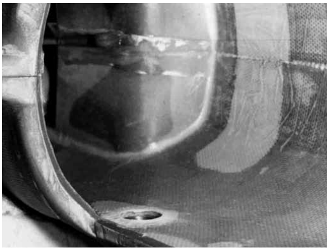
Bild 71: Die Passbolzen garantieren beim Zusammensetzen der Halbschalen den exakten Sitz der Formenhälften zueinander.
