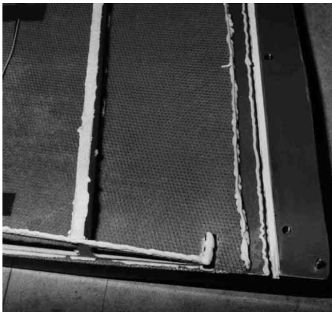
Bild 69: Die Endleiste erhält zur Versteifung 2 Klebenähte.
