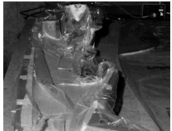
Bild 57: Besonders bei tiefen Formen wie bei der Rumpfform muss die Folie großzügig in Falten gelegt werden, damit sie überall anliegt.
