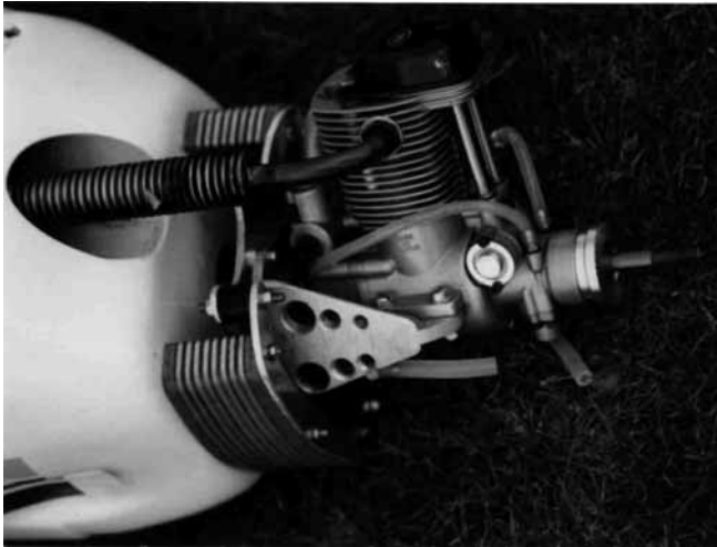
Bild 13: Im Vergleich dazu ist eine elastische Motoraufhängung bei einer konventionellen Rumpfbauweise nur sehr aufwendig zu realisieren.
