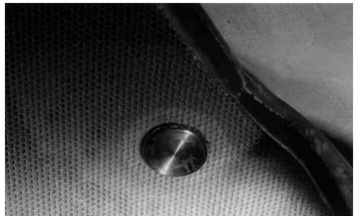
Bild 54: An den Rohrsteckungen wird das äußere Decklaminat ausgeschnitten, bevor der Bolzen soweit wieder eingeschraubt werden kann, dass er um Wabenstärke in die Form hineinragt.
