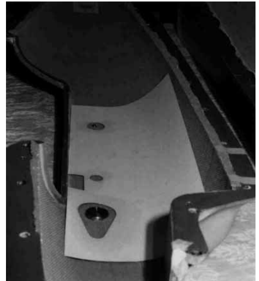
Bild 59: Schablonen markieren die Positionen, an denen der Wabenkern mit angedicktem Harz aufgefüllt wird
