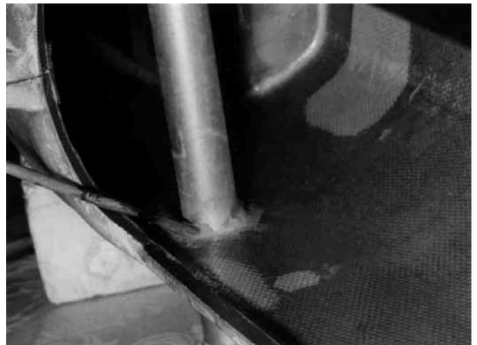
Bild 70: Die GFK-Hülse wird auf das Aluminiumrohr aufgefädelt und mit den Rumpfseitenwänden verklebt. Dadurch wird der Rumpf im Bereich der Tragflügelsteckung deutlich versteift.
