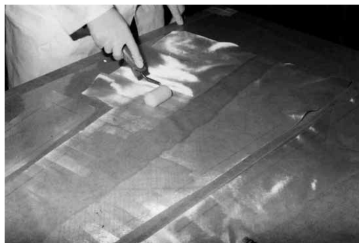
Bild 60: Das innere Decklaminat wird auf einer Folie vorgetränkt ...
