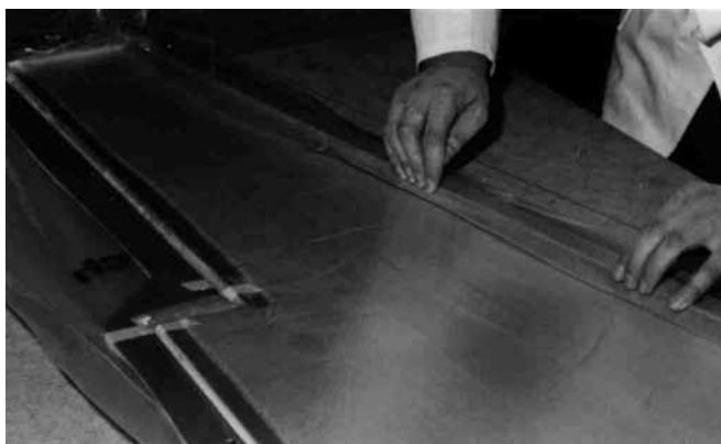
Bild 56: Flache Formen wie die Tragflächenform lassen sich dagegen wesentlich unkomplizierter im Vakuum einsetzen. Eine Faltenbildung des Folienschlauches ist hier nur in geringem Maße notwendig.
