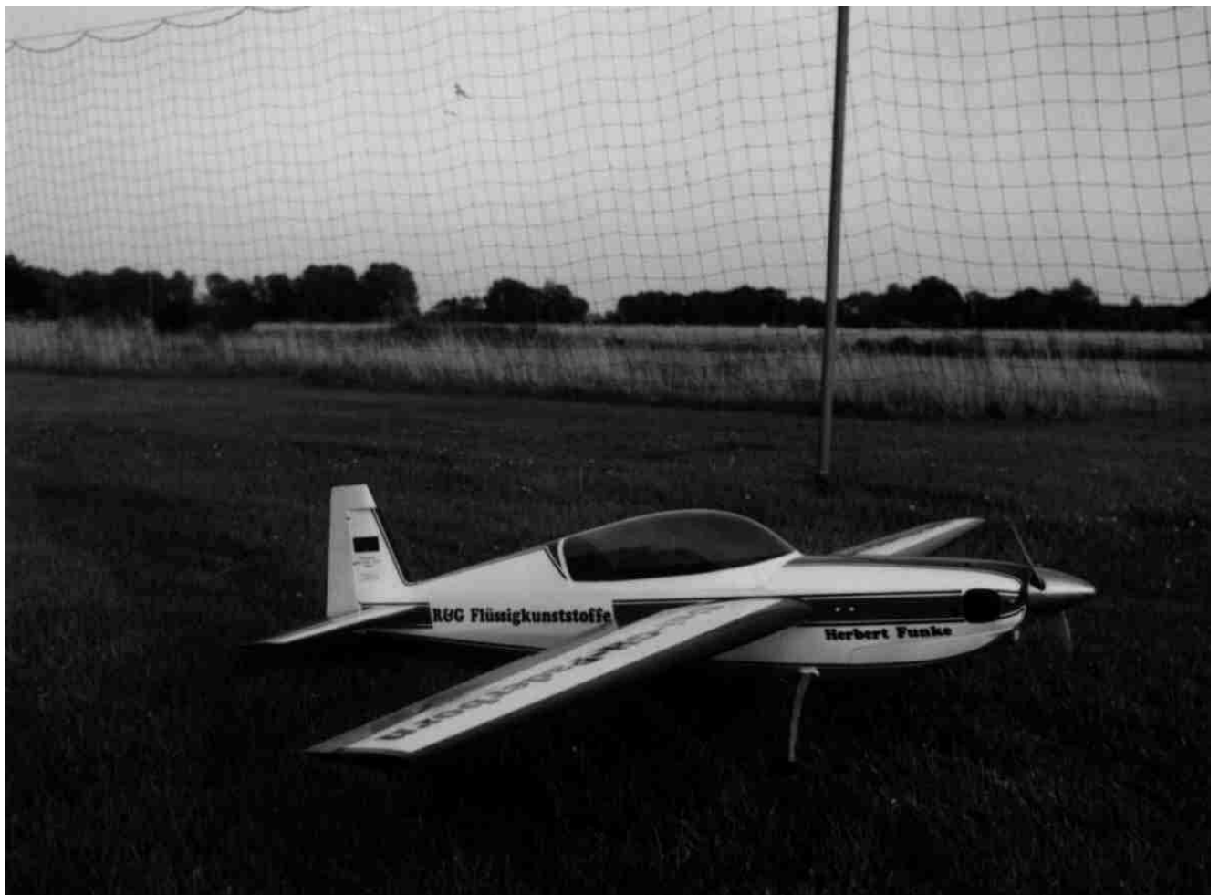
Bild 75: Das flugfertige Modell wiegt ohne Kraftstoff 4900 g. Eine strenge Gewichtsdiät in allen Bauphasen war nötig, um wie gefordert die 5 kg Grenze zu unterschreiten. Damit wiegt das Modell gut 2 kg weniger als vergleichbare F3A-X- Modelle.
