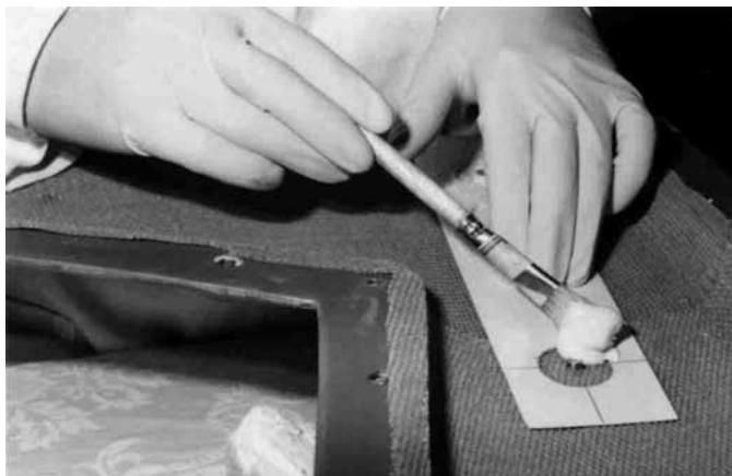
Bild 59: Schablonen markieren die Positionen, an denen der Wabenkern mit angedicktem Harz aufgefüllt wird
