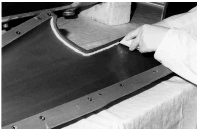
Bild 48: Ecken und Kanten werden vor dem Laminieren mit angedicktem Harz angefüllt.
