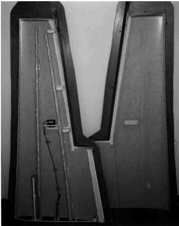
Bild 16: Die Tragflügelschalen vor dem Zusammenkleben. Deutlich zu ist die Position der Rohrsteckung.
