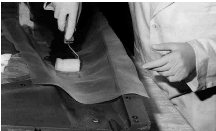
Bild 51: Flächen werden mit der Moltoprenrolle laminiert ...
