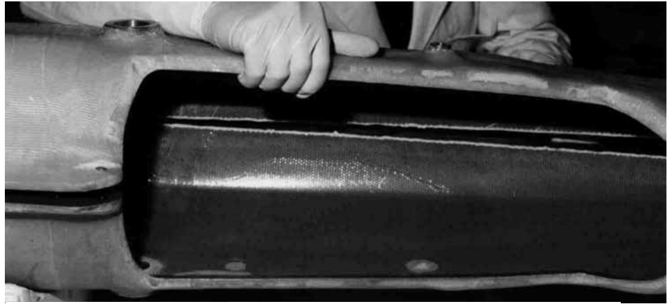
Bild 71: Die Passbolzen garantieren beim Zusammensetzen der Halbschalen den exakten Sitz der Formenhälften zueinander.
