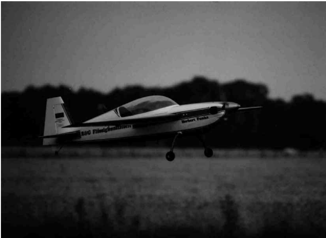
Bild 77: Aufgrund der geringen Flächenbelastung und der darauf abgestimmten Profilwahl verfügt das Modell über äußerst gutmütige Langsamflugeigenschaften.
