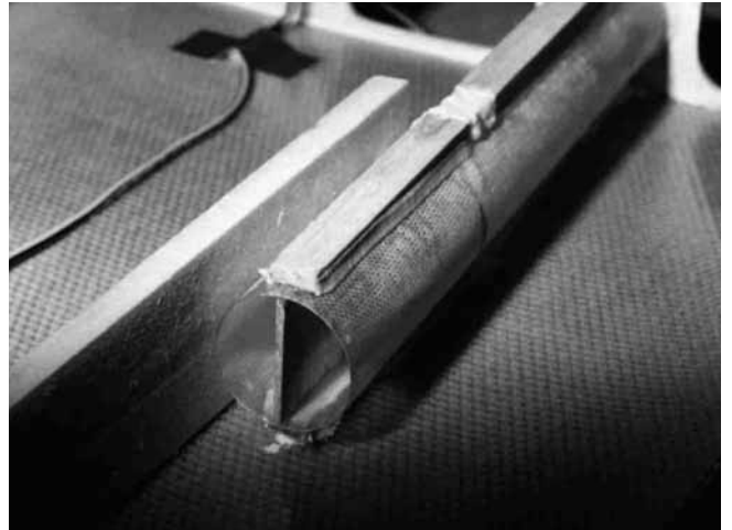
Bild 66: Zur besseren Krafteinleitung ragt die GFK-Hülse 70 mm weiter in die Tragfläche als das Aluminium-Steckungsrohr. Dieser Teil der Hülse wird mit einem Balsasteg versteift.
