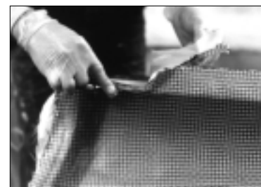
Abschneiden des überstehenden Gewebes mit einer gebogenen Spezialschere (siehe R&G-Zubehörprogramm).
