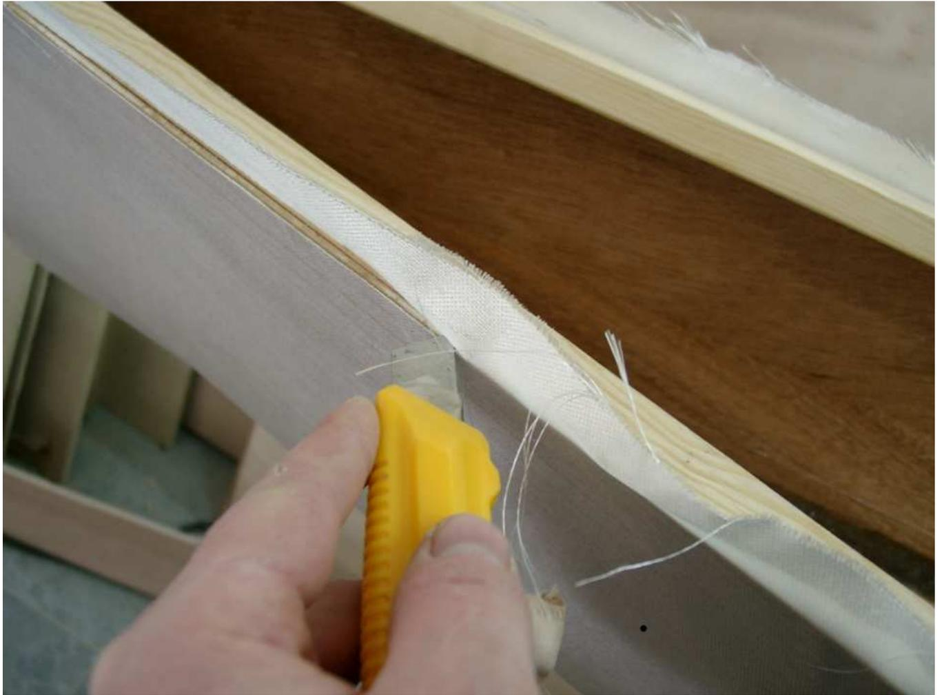
Nun werden die Deckbeams hergestellt. Die Sperrholzstreifen werden wieder mit eingedicktem (Baumwollflocken) Harz aufeinander gelegt und in eine Folie eingewickelt. Danach werden sie schrittweise auf eine vorbereitete Form gespannt und ausgehärtet.
