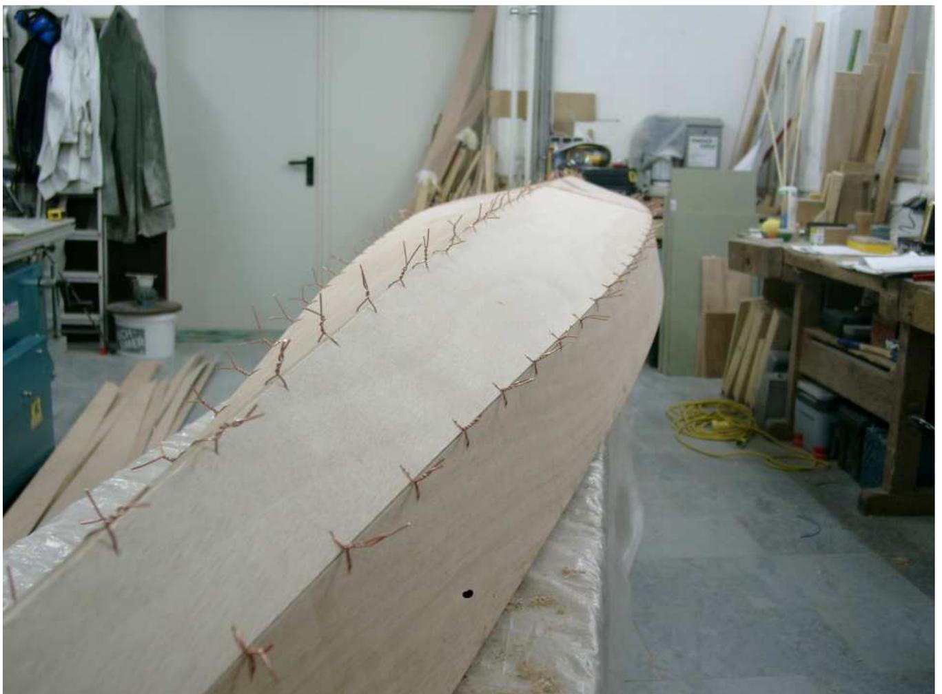
Sind alle Rumpfpfplanken vernäht, wird der Rumpf ausgerichtet und auf Twist kontrolliert. In dieser Phase entscheidet sich, wie exakt die spätere Rumpfform ist.
