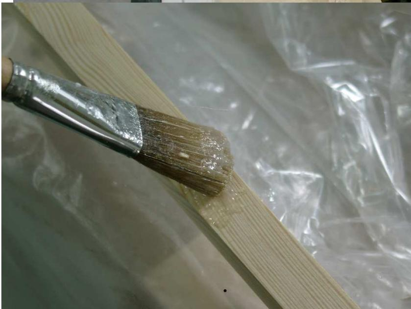
Wieder kommt mit Bauwollflocken eingedicktes Harz zur Anwendung
