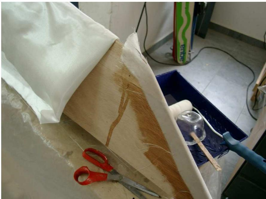
Am Bug und am Heck werden Verstärkungen aufgebracht, bevor mit dem Gewebe darüber laminiert wird.
