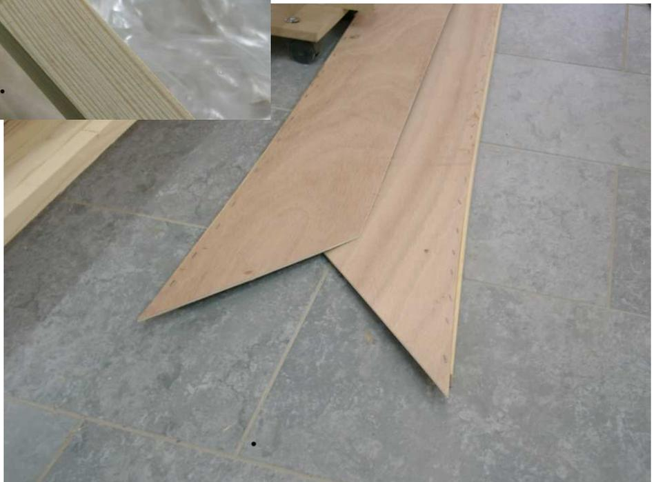
Wenn nun alle Planken geschäftet und genau ausgeschnitten und mit den Längsstringern verklebt sind, geht es ans Zusammennähen. Zum Zusammennähen wird Kupferdraht verwendet. Wer keinen Kupferdraht mit ca. 0,8 bis 1,0 mm bekommt, kann sich mit Einziehdrähten aus dem Baumarkt behelfen und diesen abisolieren.
