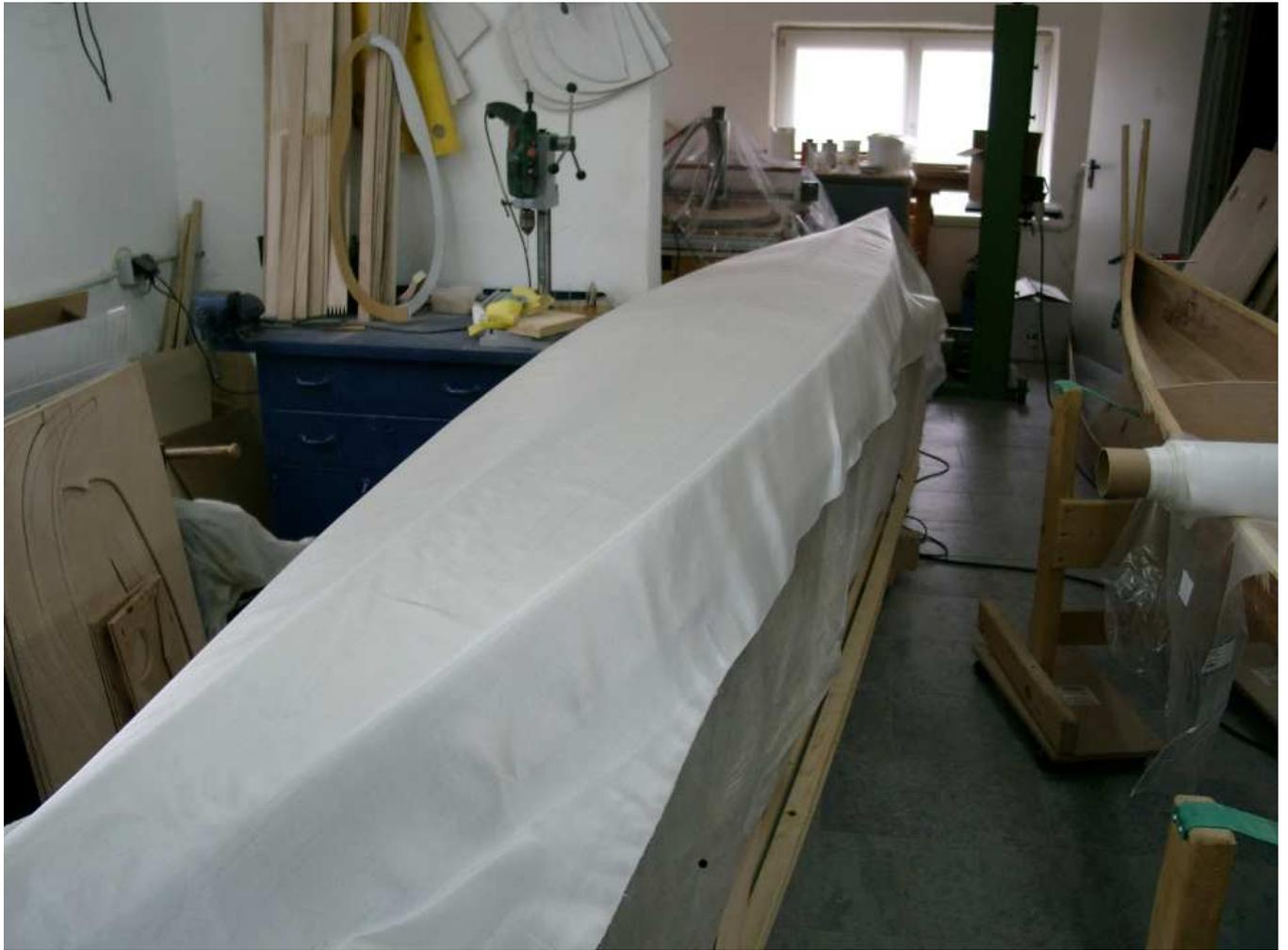
Nun wird das Harz in kleinen Mengen angemischt und mit einer Kunststoffspachtel und mit Walzen in das Gewebe eingearbeitet. Anders als bei herkömmlichem Glasgewebe wird das Glashohlfasergewebe nicht ganz transparent. Deshalb muss man besonders darauf achten, dass die ganze Fläche getränkt ist und der Kontakt mit dem Untergrund flächig gegeben ist.
