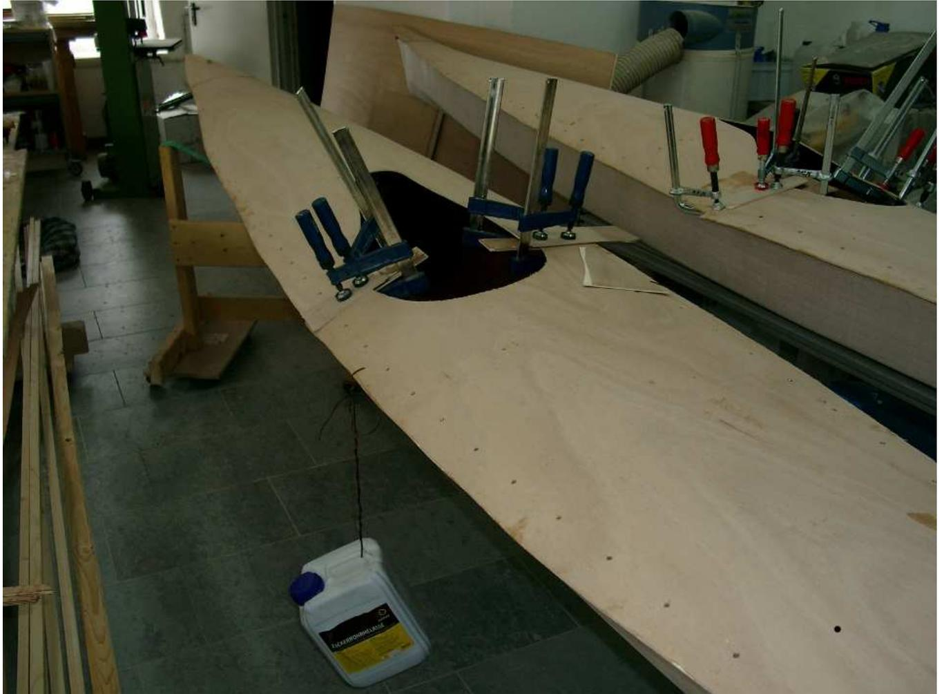
Im Folgenden werden die beiden Teile des Decks mit reichlich Zugabe zugeschnitten und auf der Unterseite mit Epoxydharz getränkt. Dann werden die Decksteile aufgesetzt und an den Decksstringern verschraubt. Zuvor werden die Decksstringer und die Deckbeams wieder mit einer eingedickten Harz-Baumwollmischung bestrichen, um eine satte Verklebung zu erzielen.
