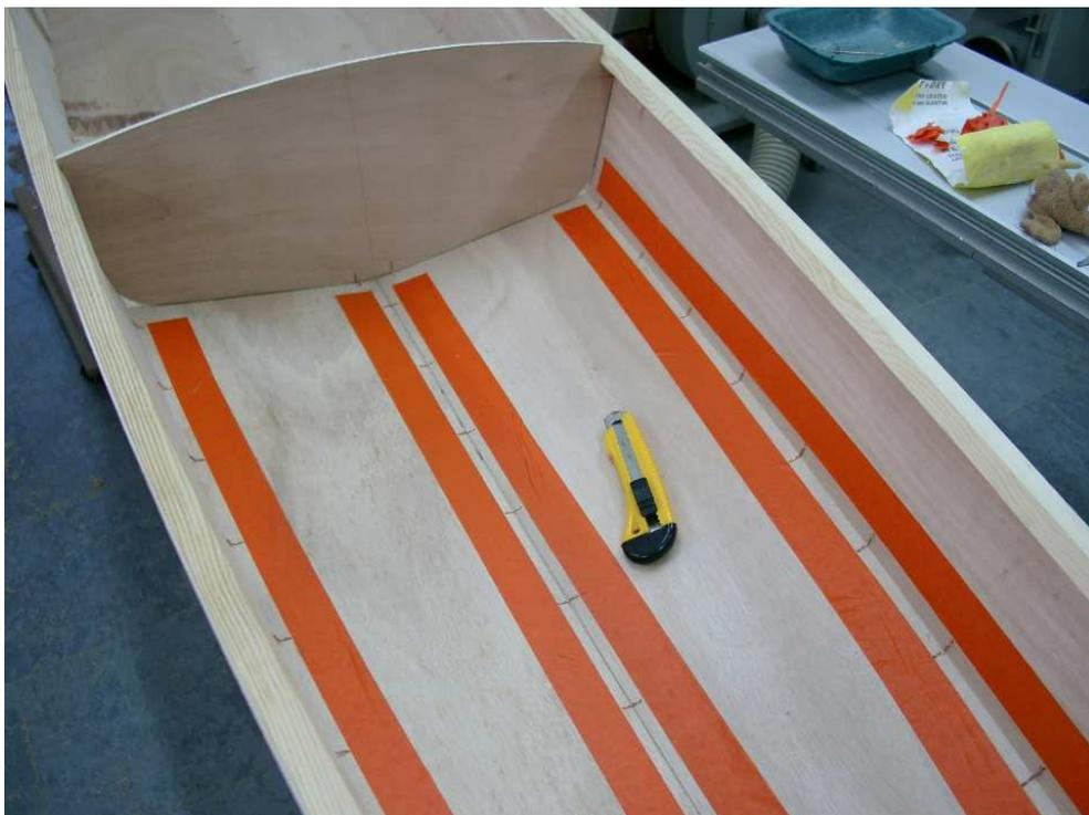
Nun wird die Innenseite vorbereitet, um die Kanten mit Harz und Glasgewebe zu verkleben. Das Abkleben mit Kreppband ermöglicht eine saubere Hohlkehle.
