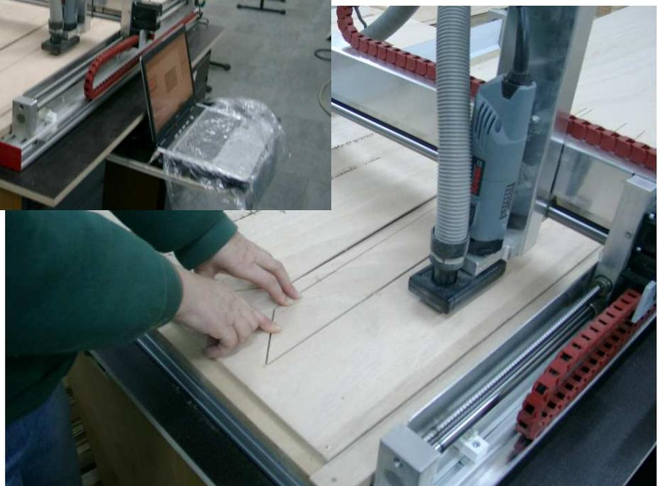
Dazu kommt, dass die Sperrholzplatten ein Maß von 2.500 mm x 1.220 mm haben. Daher ist eine Schäftung nötig. Das Sperrholz wird entweder geschäftet, indem auf beide Teile eine Schräge geschliffen wird, um eine große Klebefläche zu erreichen. Im konkreten Fall wurde die Schäftung durch eine spezielle Zinkenfräsung mit der CNC-Fräse realisiert.
