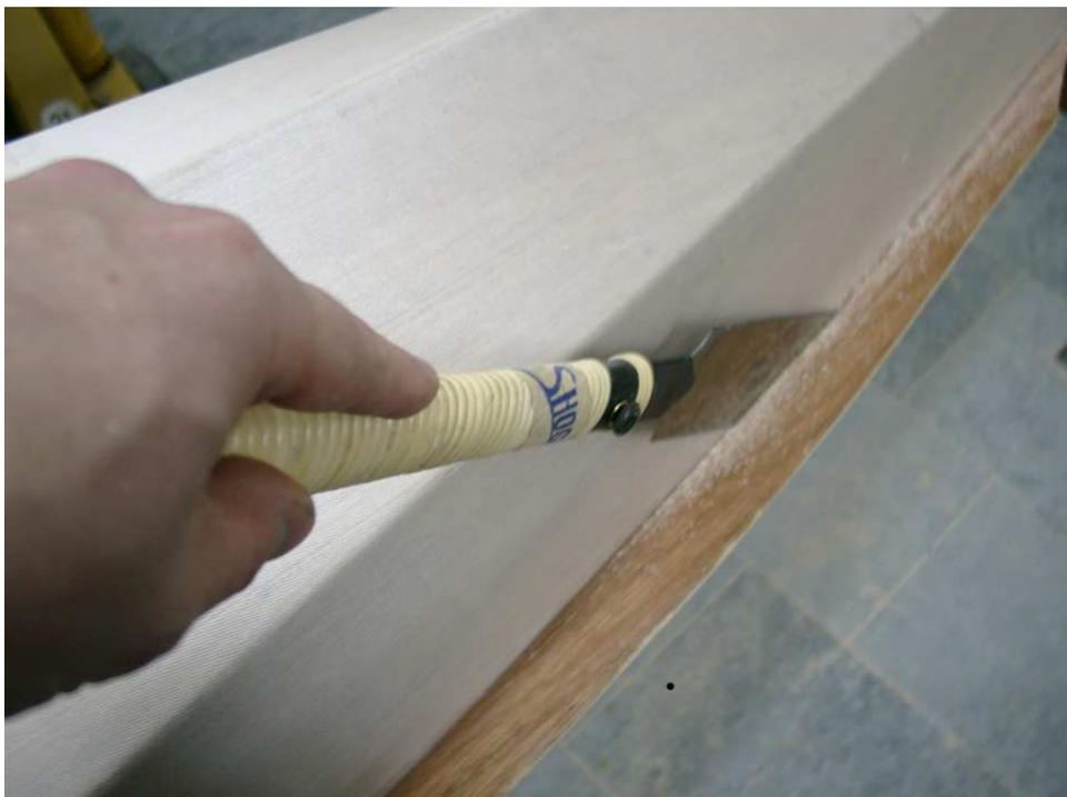
Nachdem das verklebte Deck gut ausgehörtet ist, wird das Boot umgedreht und der überstehende Rand vorsichtig mit einer feinen Säge zurechtgeschnitten.
