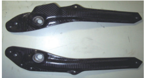
Unterzüge beschnitten, fertig
