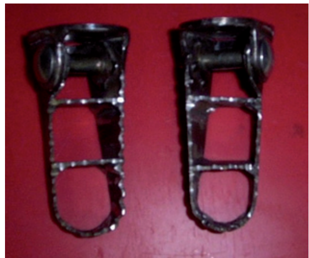
verschweißt und verschraubt
