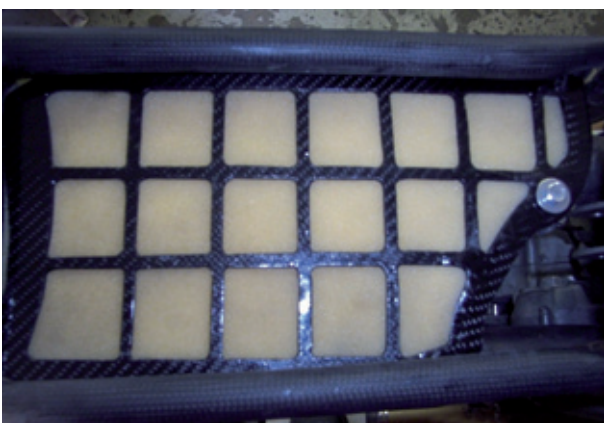
Gitter mit Filter montiert
