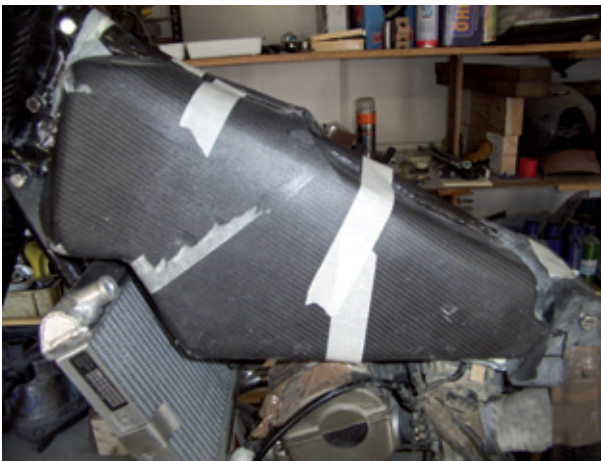
Schale entformt, beschnitten, angepasst seitlich
