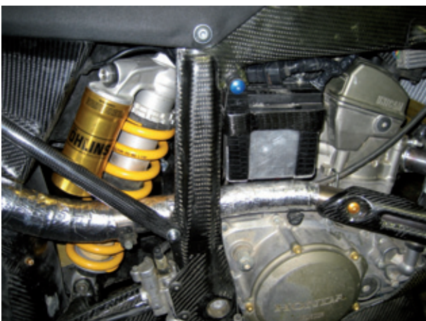
Batterie am Ort
