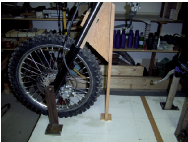
Vorderbau auf Grundplatte
