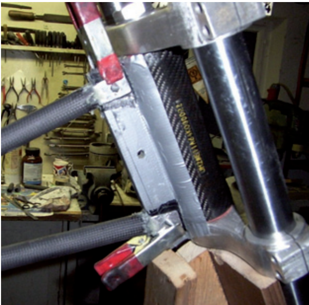
Einlegteile in Rohren
