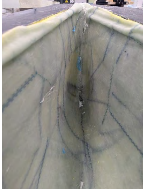
Abbildung 14 Fehlerbild: Wegen überlappen von Faserverstärkung über das Abreißgewebe nicht vollständig entfernbares Abreißgewebe, sowie vom Saum heruntergerutschte GFK-Stabverstärkung. Es wurde beim Vakuumziehen nicht ausreichend darauf geachtet, dass sich das Gewebe nicht verschiebt
