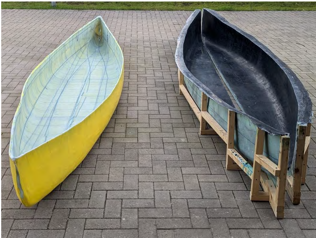
Abbildung 18 Entformtes Boot mit gereinigter Form
