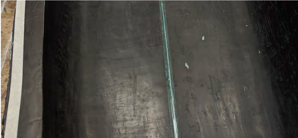
Abbildung 10 Zum laminieren vorbereitete Form, links: Kreppband zum abkleben der Fläche, auf der später das Vakuumdichtband aufgeklebt werden soll; Mitte: der mit Vakuumdichtband und Flashtape abgedichtete Verbindungspalt
