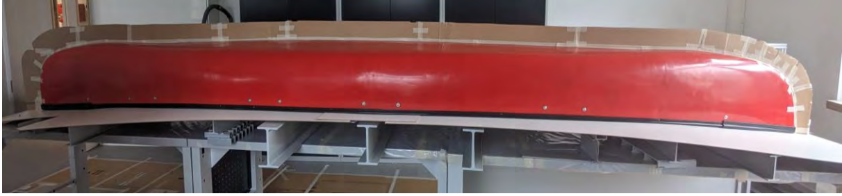
Abbildung 1 Urmodell mit Krempe am Kiel (Pappe) und Dollbord (MDF-Platte)
